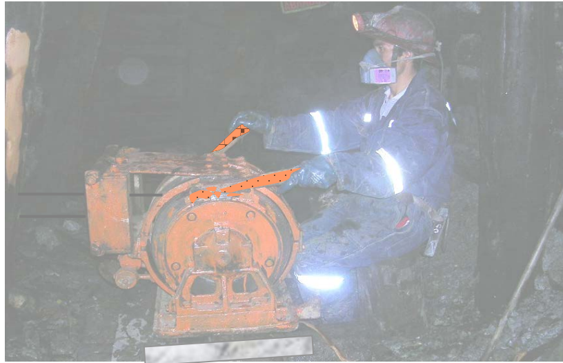
Foto 4: Winche de Arrastre de 15 hp.
