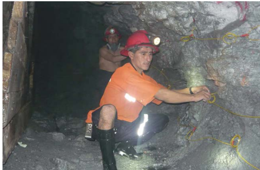
Foto 2: Personal realizando el amarre
