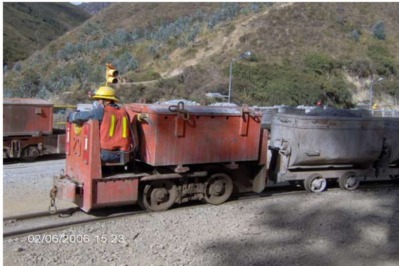
Foto 6: Locomotora de Extracción BEV 3.5 t.
