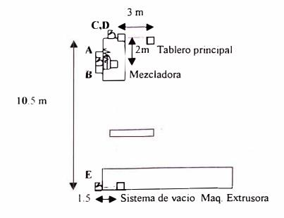
El ambiente industria reinante podría someter a los conductores a la acción de humos y humedad, por eso se ha pensado en usar cables THW, instalados en ductos para protección mecánica en la zona de mezcla y secado, mientras que para la bomba de vacío será llevado por vía aérea, mediante una estructura simple.
