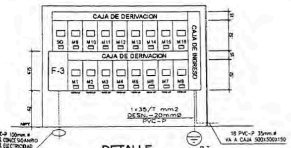
DETALLE BANCO DE MEDIDORES ESC: 1/25
