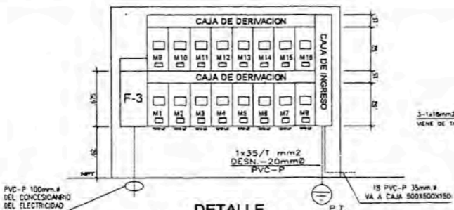
DETALLE BANCO DE MEDIDORES ESC: 1/25
