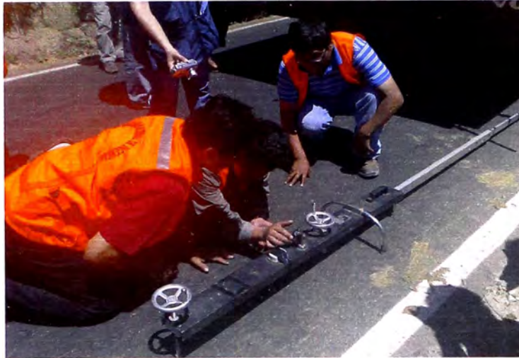
Figura N° 4.2 LECTURA DE LAS DEFLEXIONES CON DIAL.
