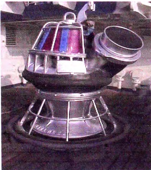
Figura 20 El absorbente, usado para trasladar la mezcla de pescado y agua desde la bolsa de red hasta la parrilla de la bodega.
