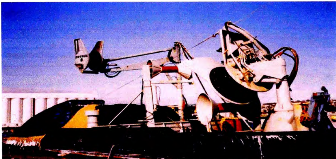
Figura 19 Sistema Net-Winch y Net-Stacker en conjunto
