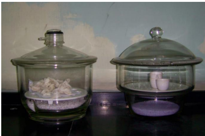
Figura 29. Campana Extractora de Humedad
