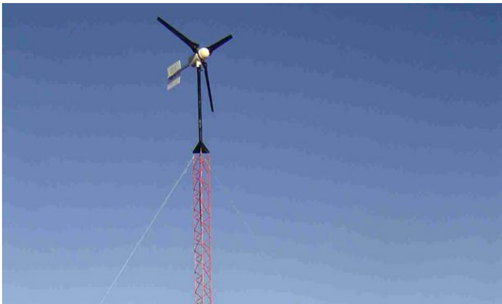
Fig. 1.4 : Aerogenerador de 3 kW en Comodoro-Patagonia por Tecnotrol http://www.elpatagonico.net/nota/162342/
