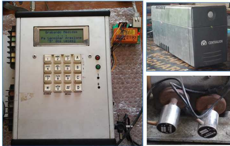
Figura N° III-11 Izquierda: Equipo de medición “StrainIndicator”; Derecha superior: UPS batería para trabajo continuo de medición; Derecha inferior: Sensores de medición.
