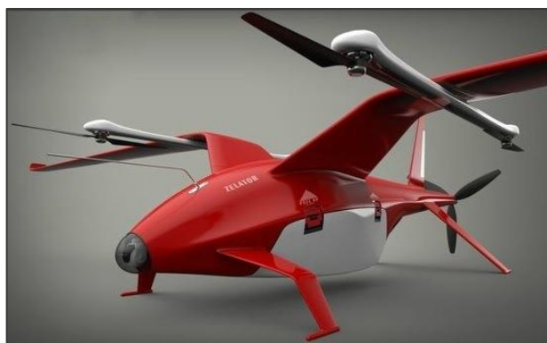
Figura N° 2.13 Vehículo aéreo no tripulado Híbrido
