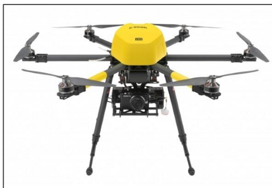
Figura N° 2.11 Ala rotatoria o multirrotor
