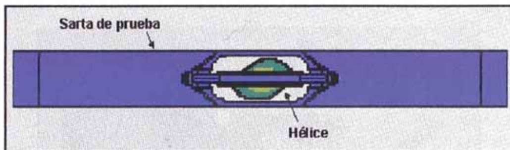
Figura N° 2.11 Medidor de flujo continuo
