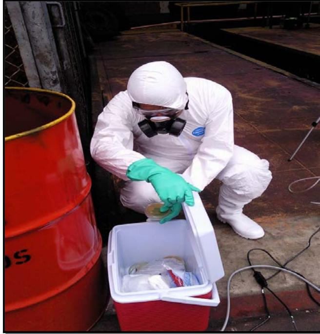
*Foto 10: Imagen donde se aprecia el momento en que se almacenan las muestras tomadas in situ, para su posterior traslado al Laboratorio*
