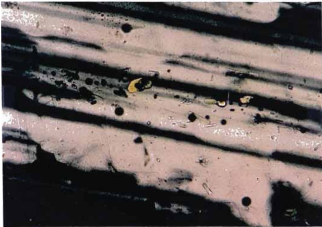
Foto 4.4.- B1, plagioclasa maclada mostrando inclusiones de magnetita en cristales octaédricos y apatita. Luz polarizada x 200.
