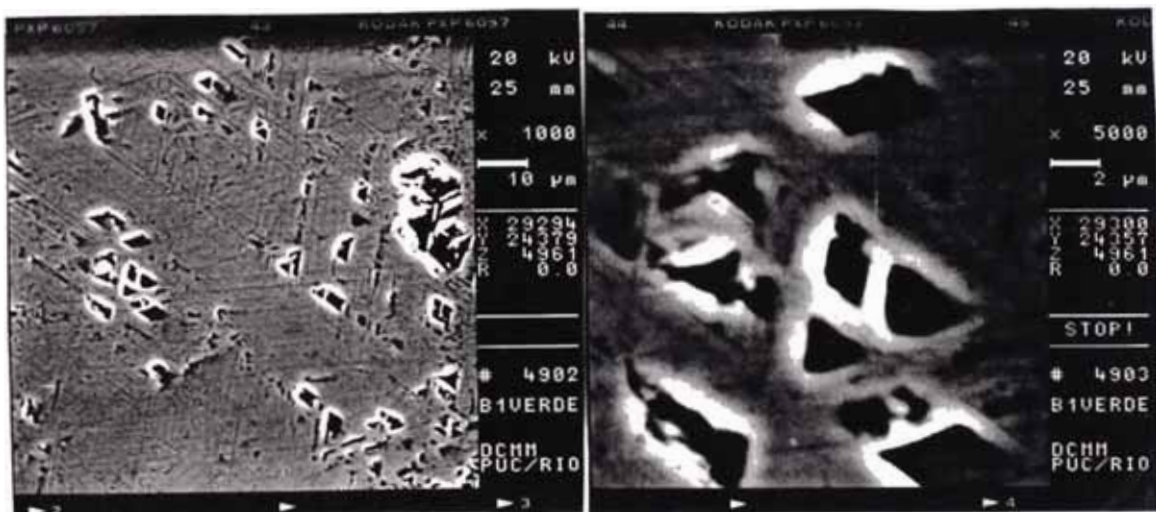
Foto 4.10.- B1-verdes x 1000, fotografía SEM 4902 mostrando grano de óxido de Fe con estructura laminar en tres direcciones. 4903 anterior x 5000.
