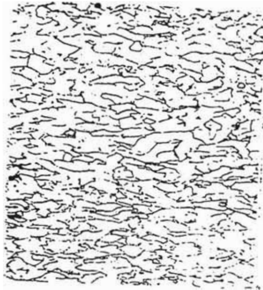
Fig. 15.- Micrografía mostrando granos alargados en zona de adelgazamiento.
