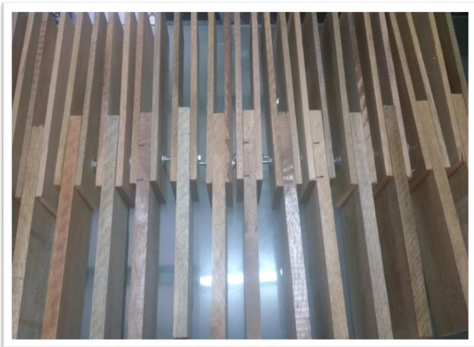
Fotografía N° 5.13- Probetas armadas de un perno.
