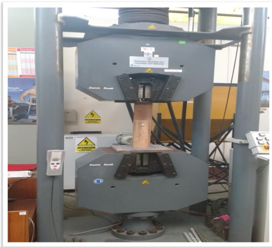
Fotografía N° 5.4- Maquina Zwick Roell de 1000 KN
