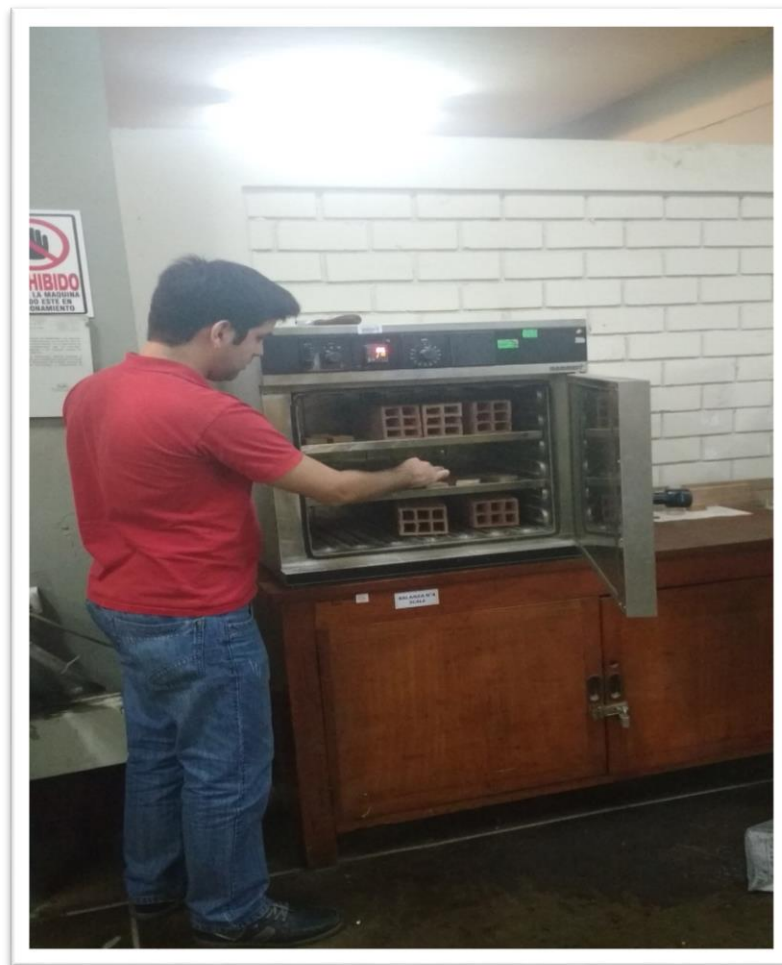
Fotografía N° 5.19- Muestras introducidas al horno.
