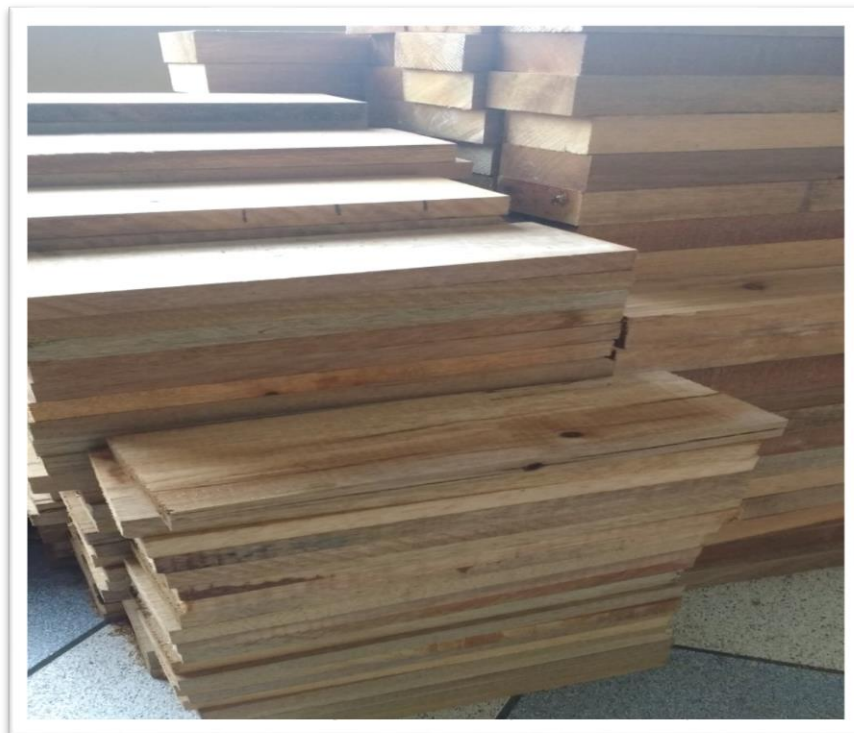
Fotografía N° 5.11- Acondicionamiento de las piezas según medidas.
