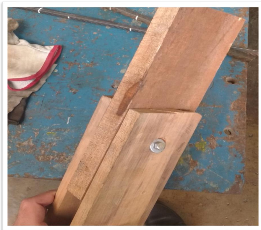
Fotografía N° 5.3- Probeta para los ensayos preliminares
