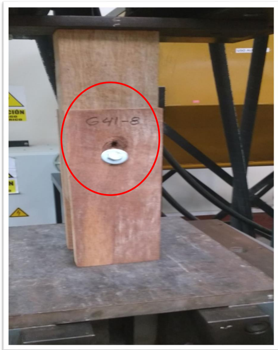
Fotografía N° 5.16- Probeta en el proceso de doble cizallamiento a compresión.
