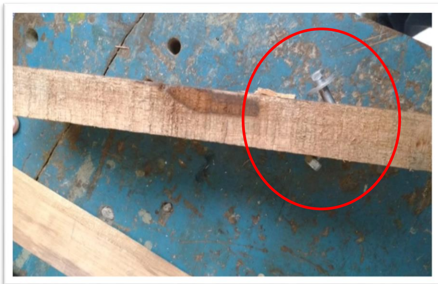
Fotografía N° 5.6- Deformación del perno en muestra ensayada.
