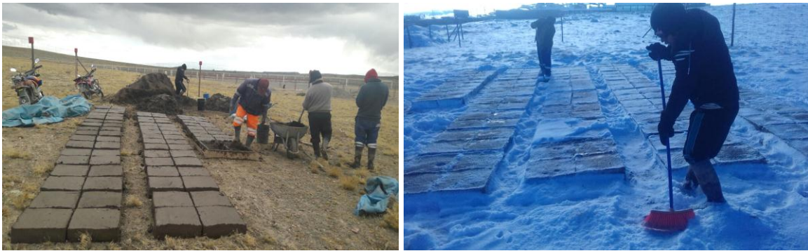
Figura 1. (Izq.) Moldeado del barro con ichu y vista de los adobes, (der.) retirando la nieve caída en plena elaboración de adobe en el mes de julio. La nieve llegó a una altura de 10 cm.
