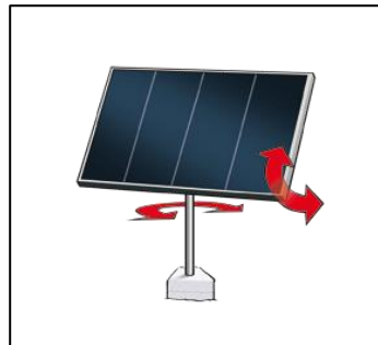
Figura 3.05: Sistema de seguimiento solar de dos ejes
