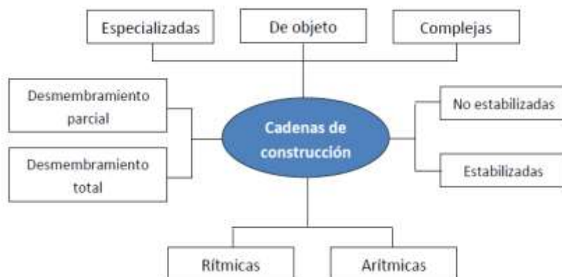
Figura 2.7: Variedades de cadenas de construcción Fuente: M.S. Budnikov, 1961
