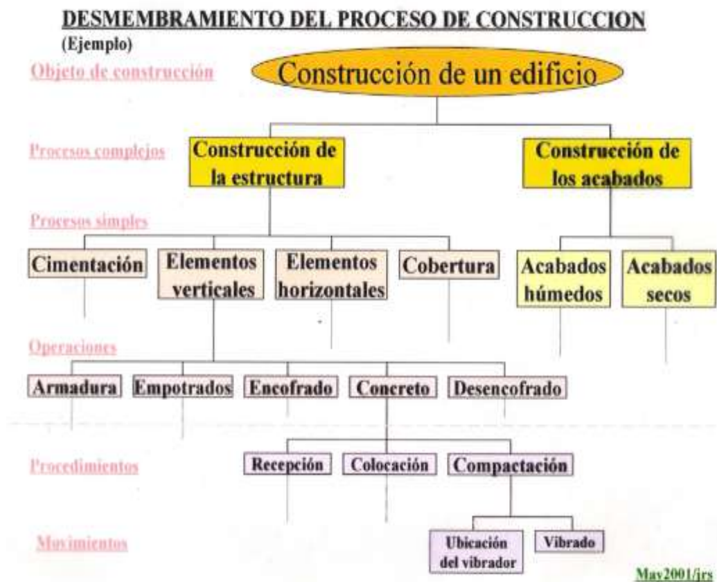
Figura 2.6: Esquematización del desmembramiento de un Objeto de Construcción. Fuente: Apuntes de clase – 2015
