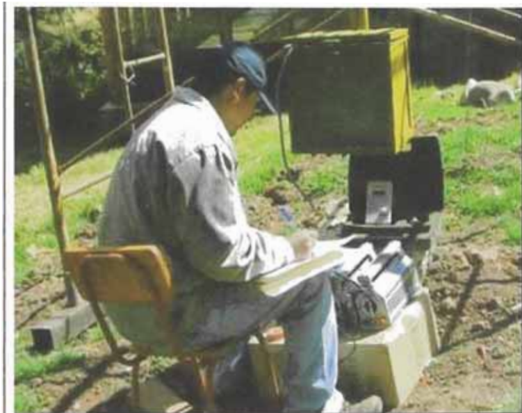
Fig. 12 Toma de datos de radiación solar, temperatura ambiente, y voltaje - corriente del controlador del SFV.
