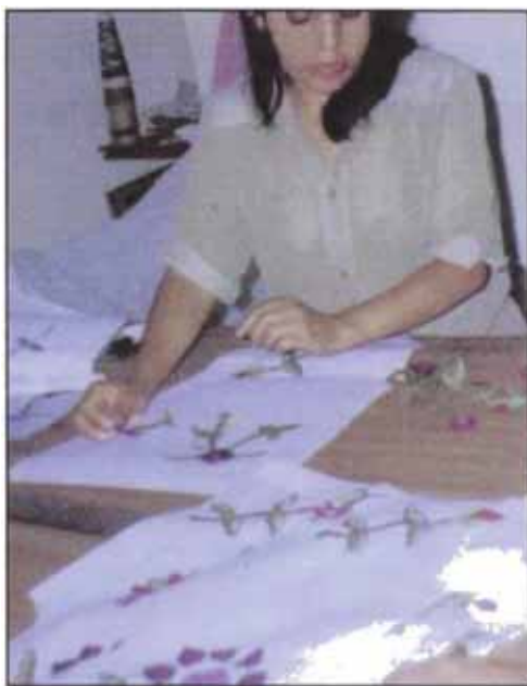
Fig. 13: Operaria fijando aplicaciones de flores hechas a crochet en el molde elaborado de un cárdigan para damas.
