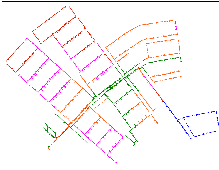
Gráfico Nro. 4.6. Diagrama Unifilar de Red de Baja Tensión
