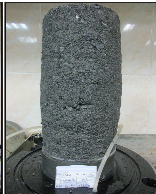
ESPECIMEN 3 Esfuerzo Efectivo Inicial 1609 kPa
