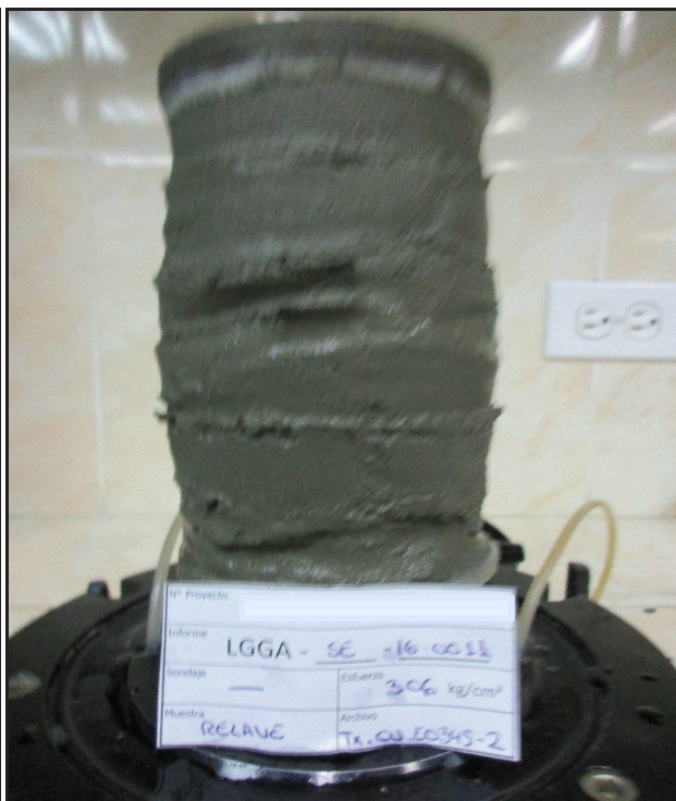
ESPECIMEN 2 Esfuerzo Efectivo Inicial 301 kPa
