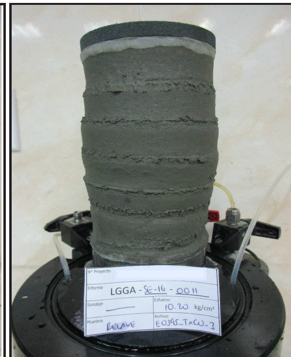
ESPECIMEN 3 Esfuerzo Efectivo Inicial 1006 kPa
