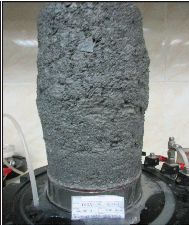
ESPECIMEN 2 Esfuerzo Efectivo Inicial 805 kPa
