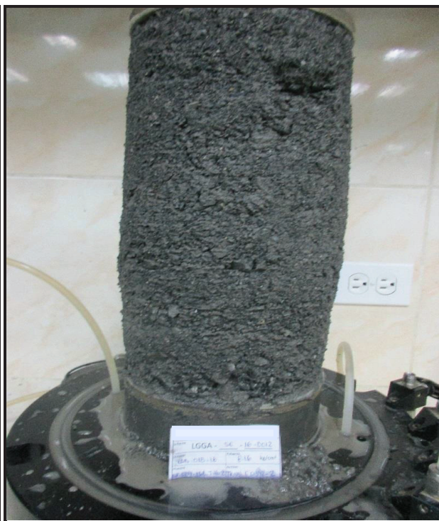
ESPECIMEN 2 Esfuerzo Efectivo Inicial 804 kPa
