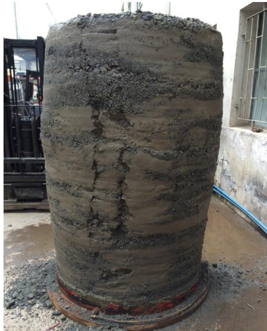
Foto 4: Probeta 100x180 cm ensayada a 5.0 kg/cm 2
