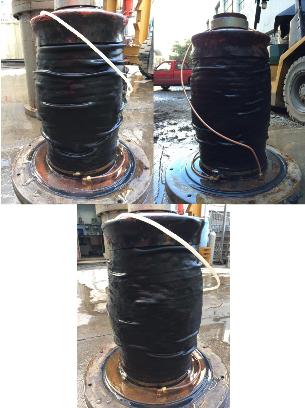
Foto 3: Ensayo 30x60 cm. Probetas 5 – 10 -20 kg/cm 2
