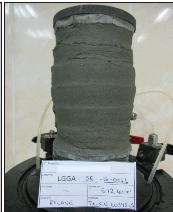
ESPECIMEN 3 Esfuerzo Efectivo Inicial 607 kPa
