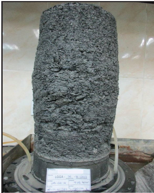
ESPECIMEN 1 Esfuerzo Efectivo Inicial 403 kPa
