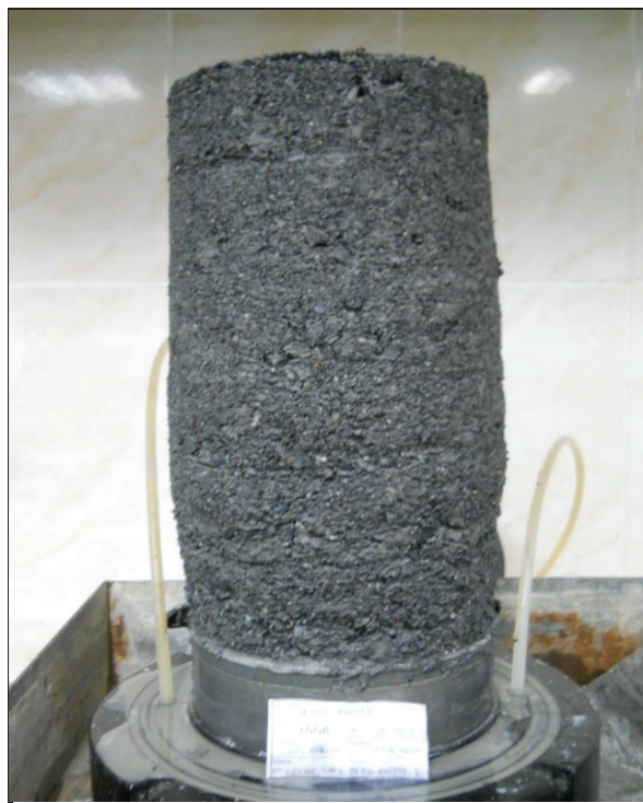
ESPECIMEN 1 Esfuerzo Efectivo Inicial 412 kPa
