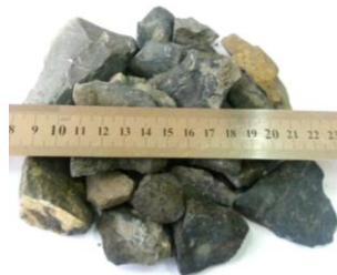
Figura N°6-15: Forma angular de las partículas del enrocado extraído de la cantera Fuente: Archivo Fotográfico Propio
