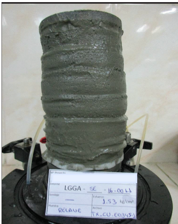
ESPECIMEN 1 Esfuerzo Efectivo Inicial 154 kPa
