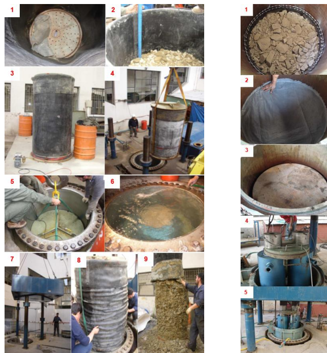
Figura N°5-12: Ejecución de ensayo triaxial a gran escala (izquierda), Ejecución de ensayo oedométrico a gran escala (derecha),
