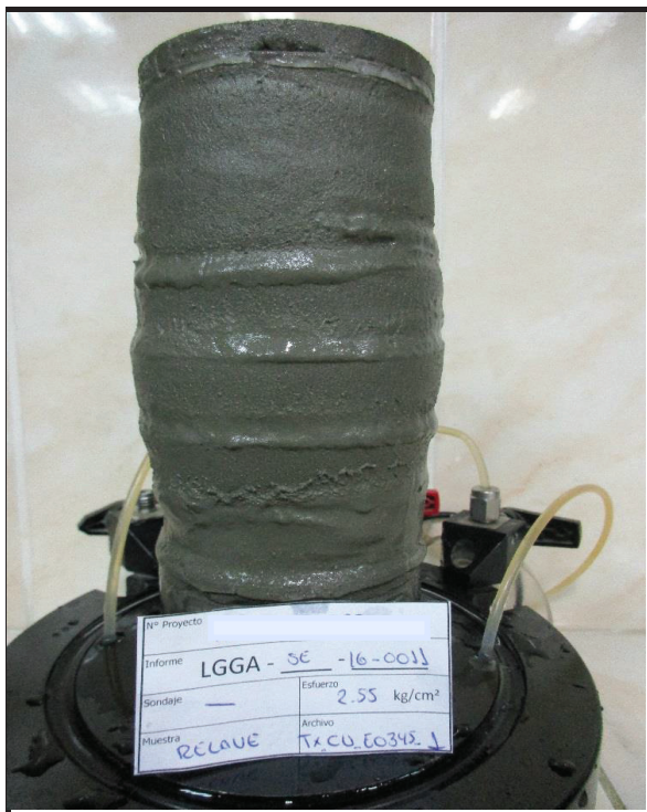
ESPECIMEN 1 Esfuerzo Efectivo Inicial 247 kPa
