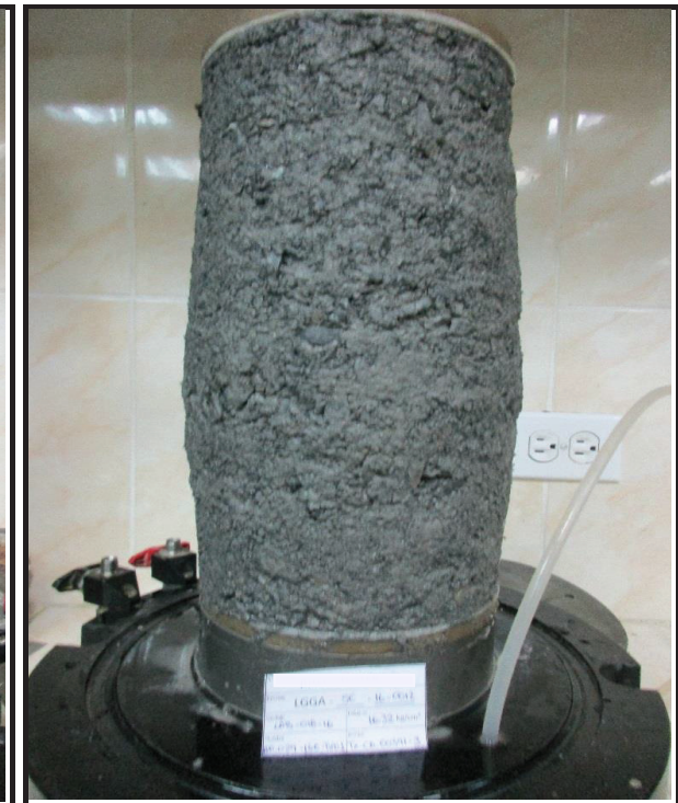
ESPECIMEN 3 Esfuerzo Efectivo Inicial 1623 kPa
