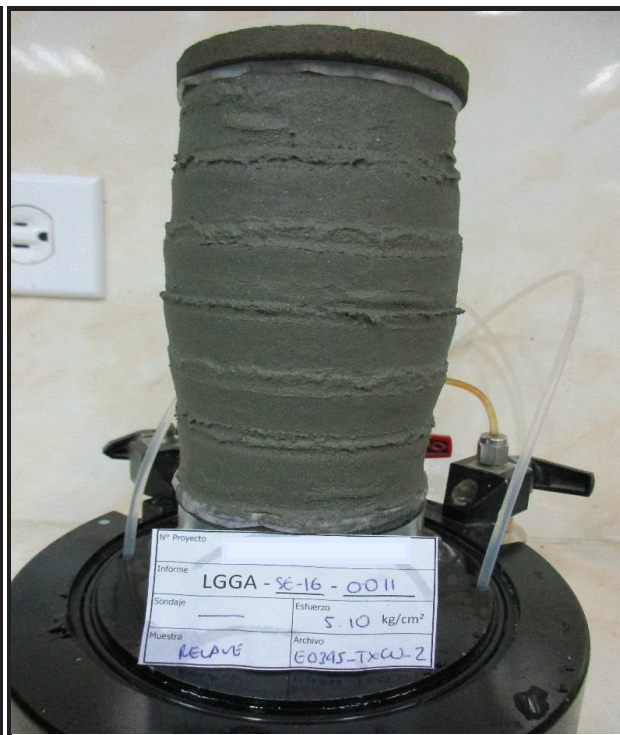
ESPECIMEN 2 Esfuerzo Efectivo Inicial 500 kPa
