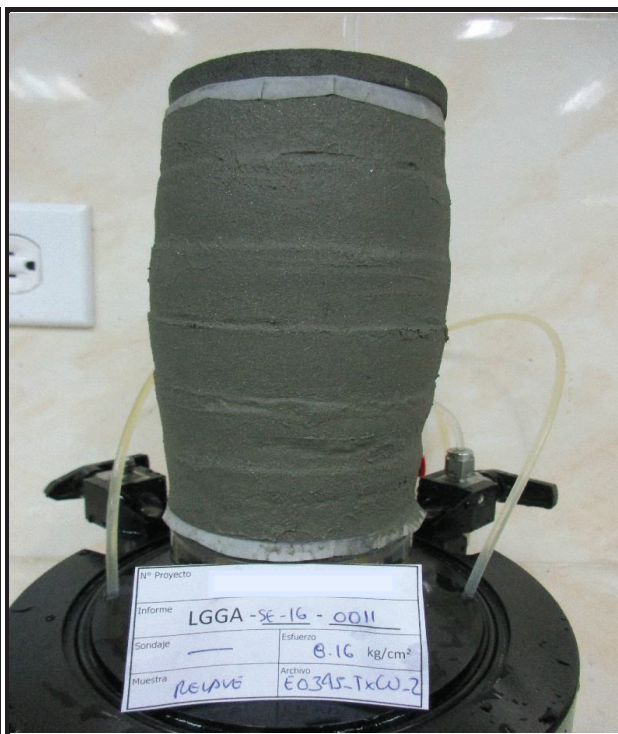
ESPECIMEN 2 Esfuerzo Efectivo Inicial 803 kPa
