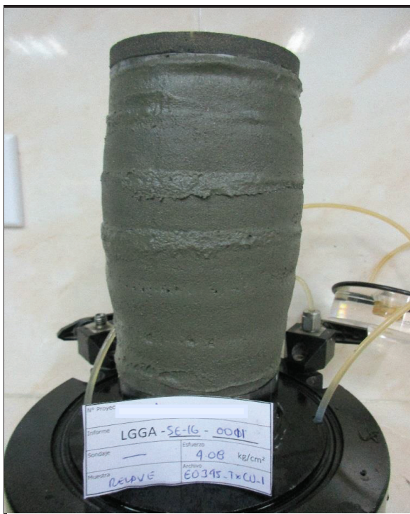
ESPECIMEN 1 Esfuerzo Efectivo Inicial 403 kPa
