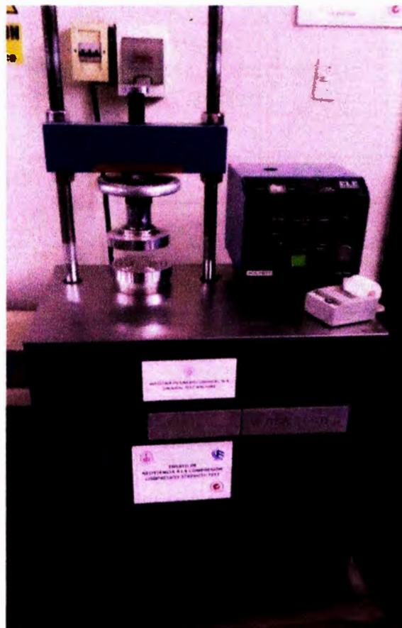
Figura 36. Máquina de ensayo uniaxial.
