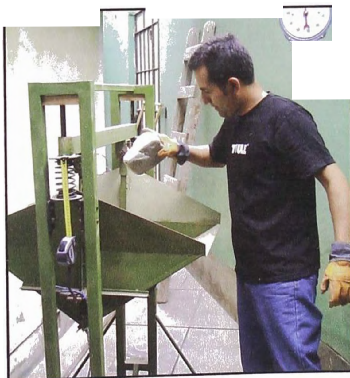
Fotografía 4.3.2.b: Colocación de gravas a dosificador de agregados
