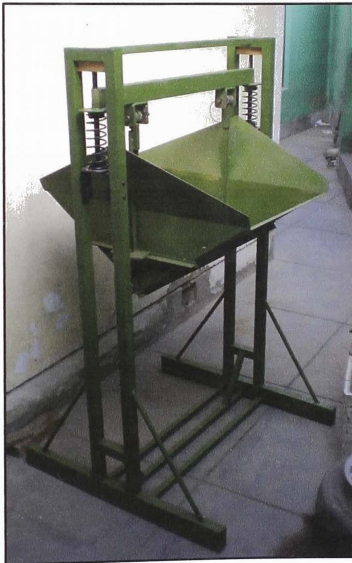
Fotografía 4.3.1.d: Dosificador de agregados ensamblado
