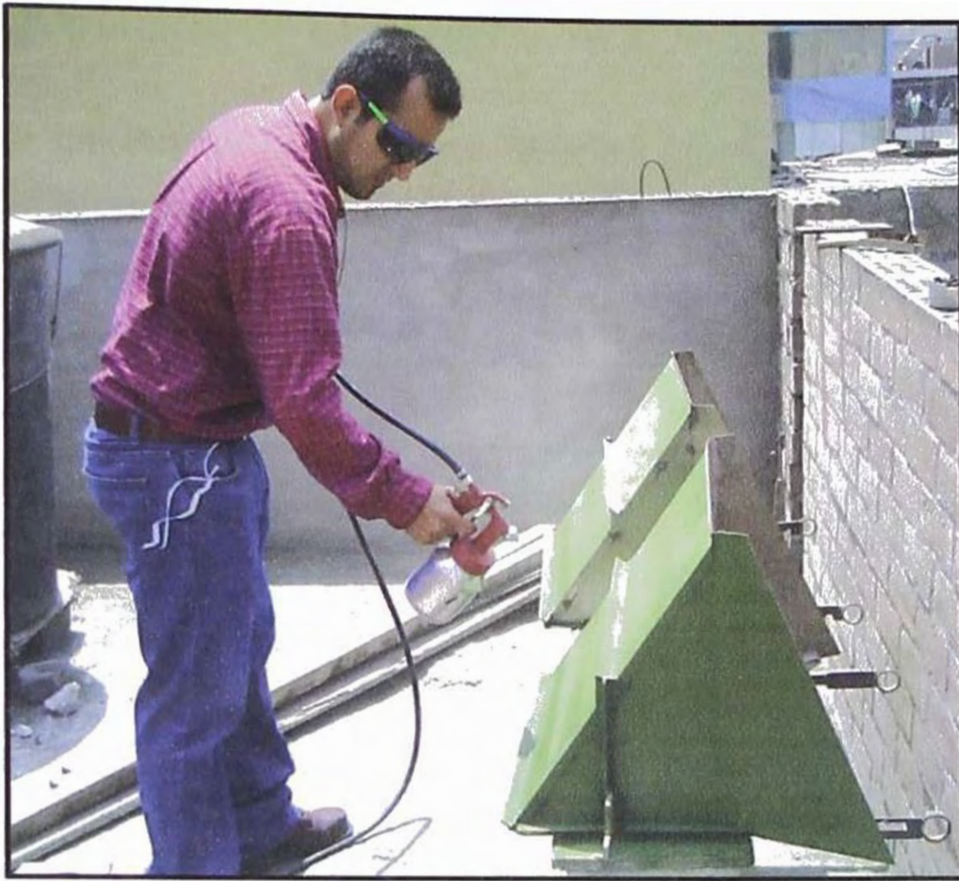
Fotografía 4.3.1.c: Pintando Cucharones con Anticorrosivo
