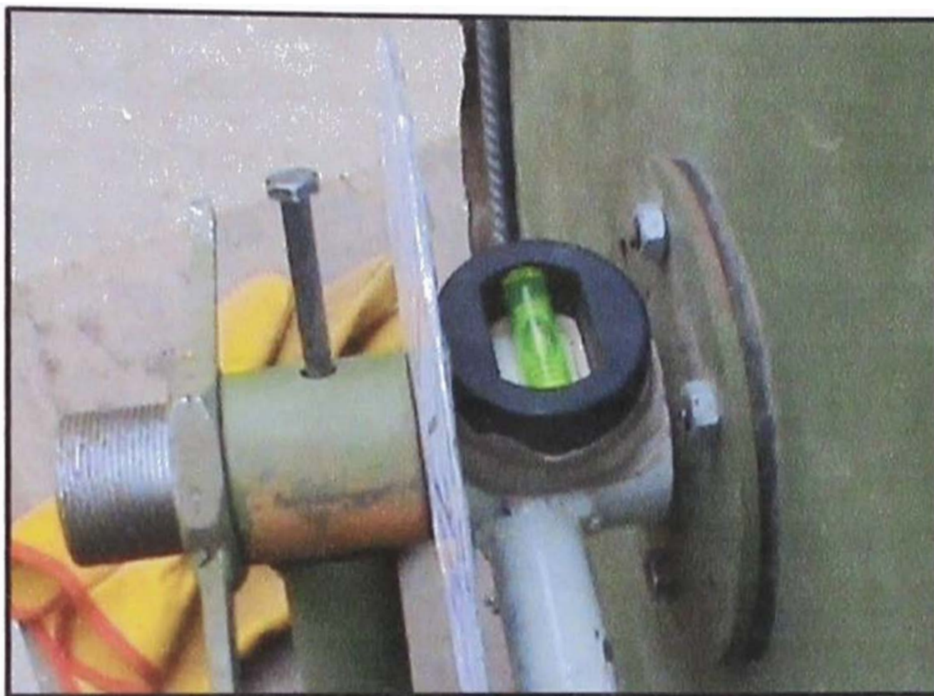
Foto 4.2.2.c: Nivel de burbuja indicando horizontalidad
