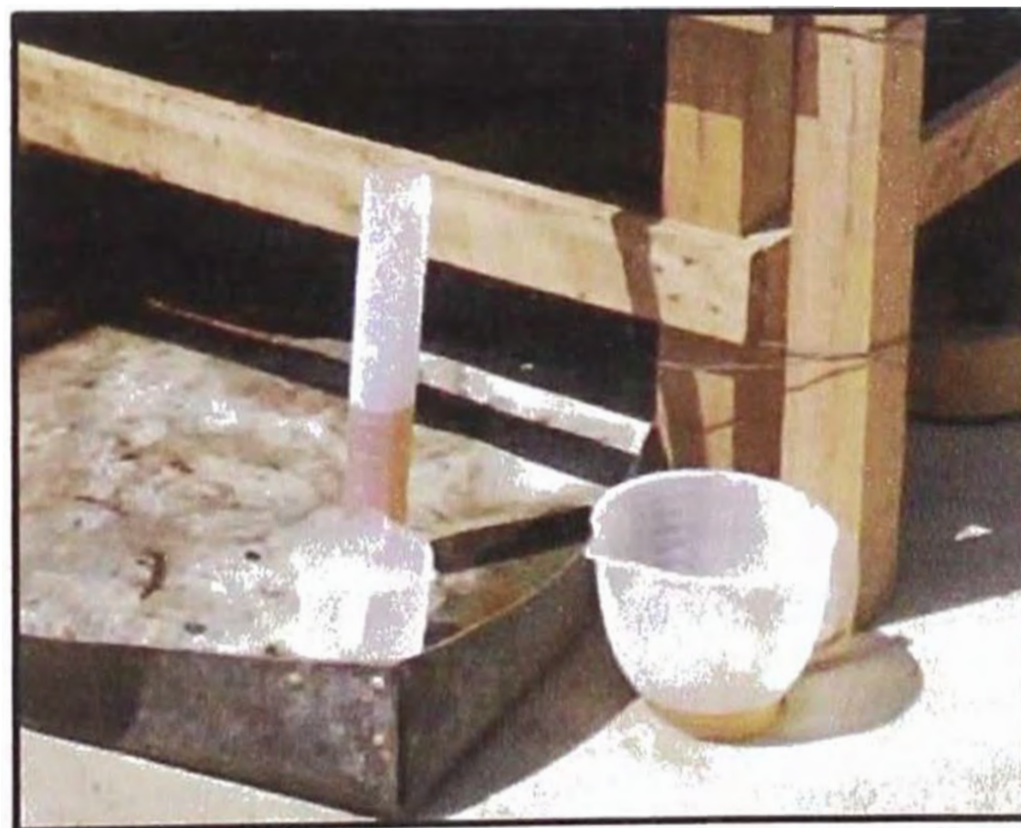
Fotografía: recipientes empleados en proceso de dosificación ( R1: Recipiente de 2 lt., R2: Recipiente de 0.5lt, Probeta Graduada )
