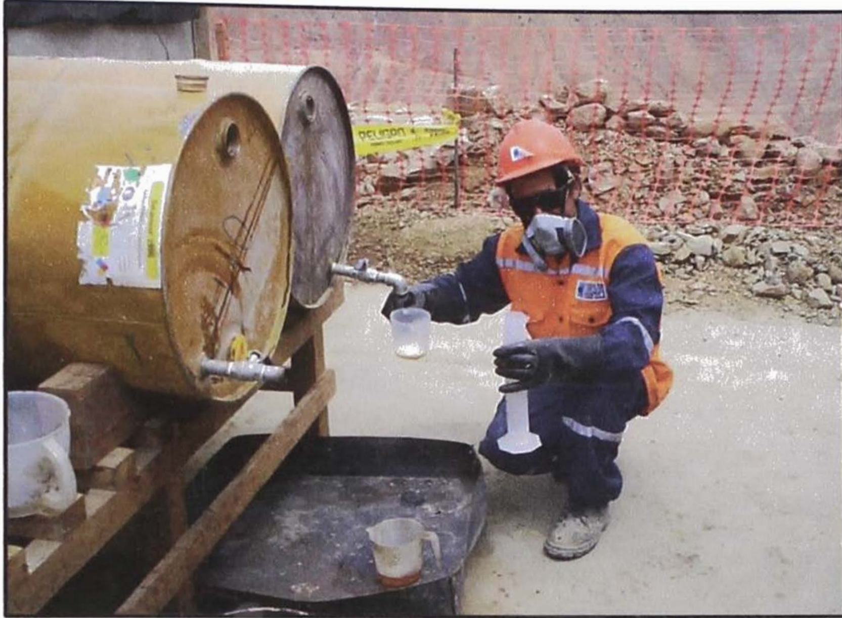
Fotografía: Ayudante de laboratorio empleando recipientes y probeta graduada para dosificado manual de aditivo liquido Sika Aer.
