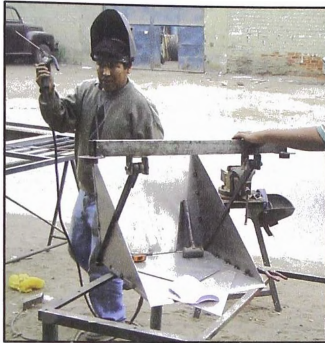
Fotografía 4.3.1.a: Reforzando soldadura en cucharones
