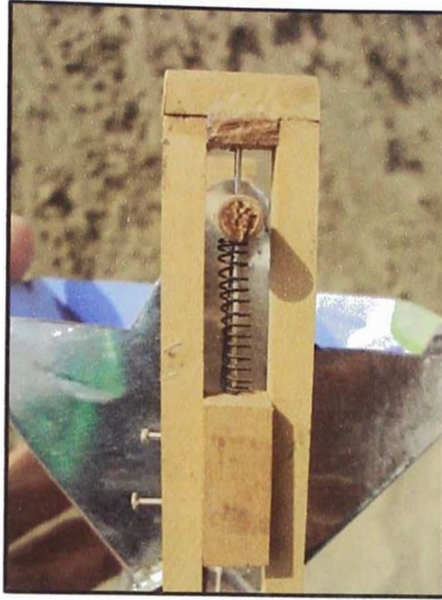
Foto 2.3.9.C: Resorte conteniendo eje pivotante
