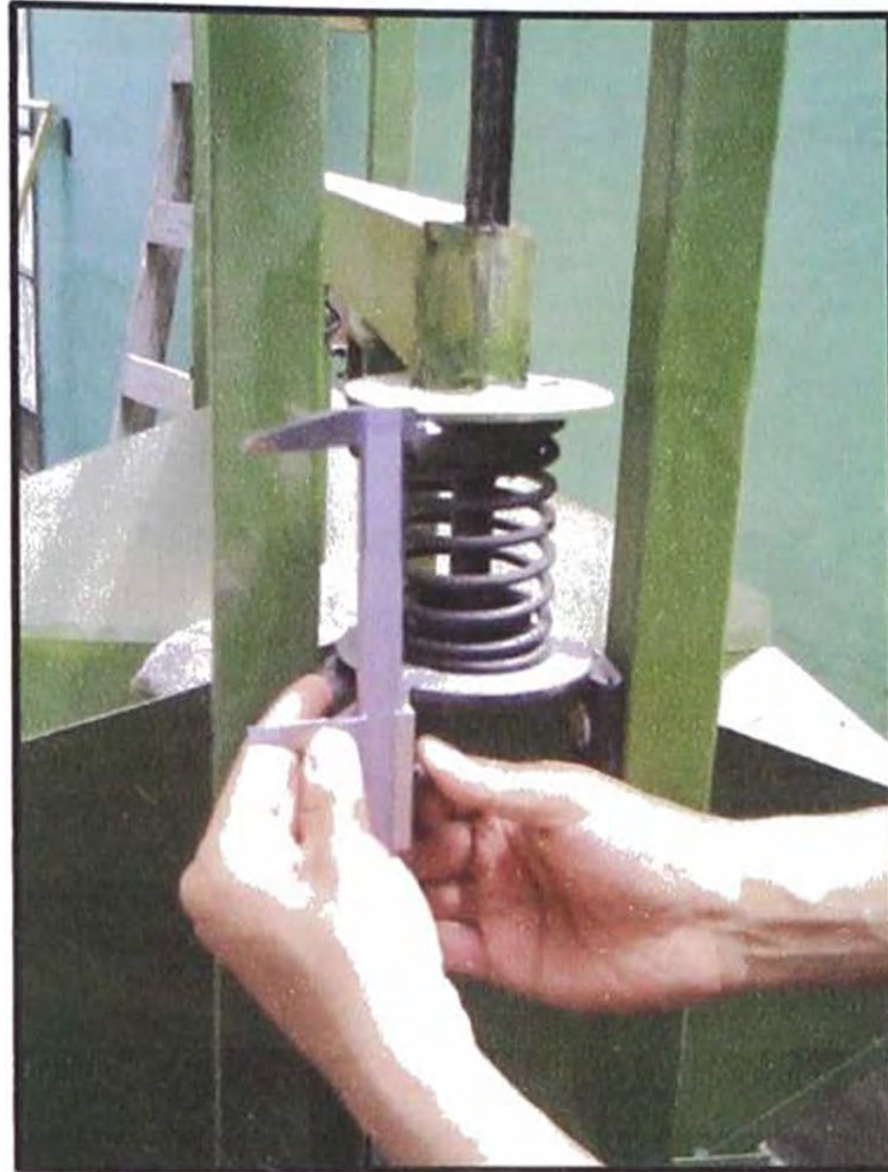
Fotografía 4.3.2.c: Medición de la longitud de deformación del resorte
