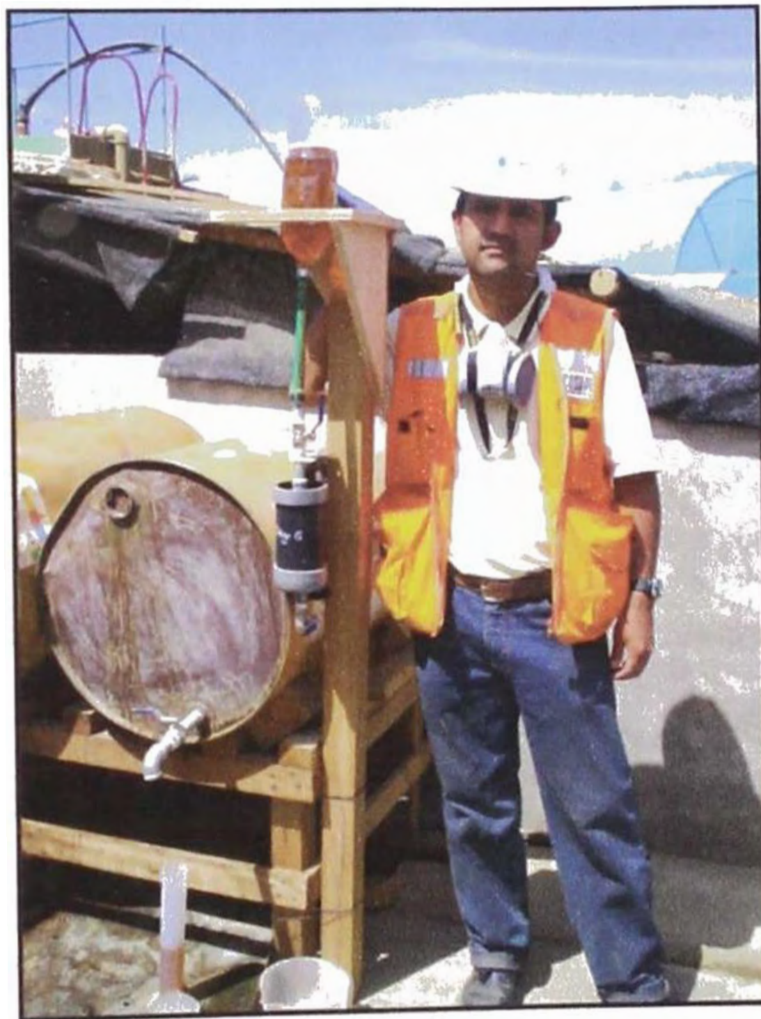
Foto 4: Primer ensayo en obra de equipo dosificador de aditivos líquidos para concreto, Planta de Concreto Cosapi – Obra: Planta de Procesamiento de Minerales de Milpo,
