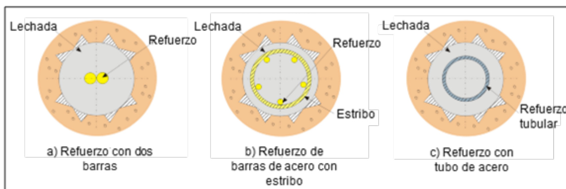
FIGURA 2.1: Clasificación de micropilotes de acuerdo al tipo de armadura (Hernández, 2012)
