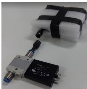
Figura 54. Aislamiento acústico de electroválvula para reducir la intensidad de sonido generada por la conmutación
