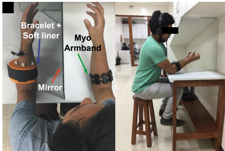
Figura 59. Sistema de validación, se muestra brazo izquierdo y derecho del participante. El brazo izquierdo viste la matriz de actuadores con el brazalete de PLA, mientras que el brazo derecho viste el Myo armband. El espejo se muestra entre ambos brazos y se utilizó para fijar la atención del participante en solo el reflejo de su brazo derecho (adaptado de Huaroto et al. [16])
