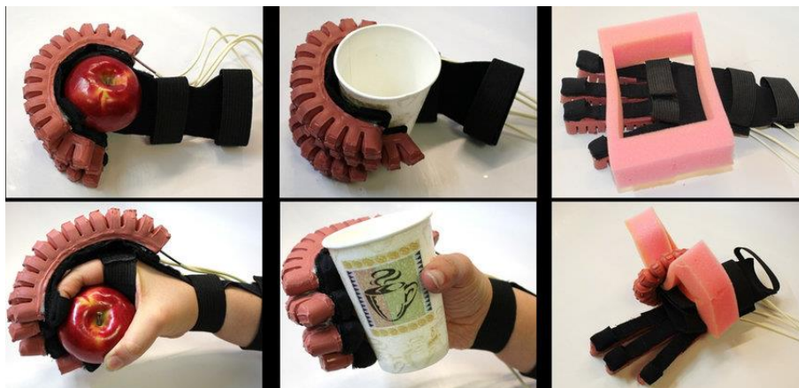
Figura 24. Guante para rehabilitación de pacientes con accidente cerebro vascular (adaptado de Polygerinos et al. [40])
