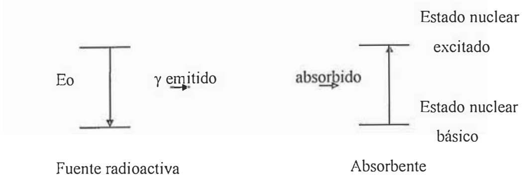
Figura 6.3. Esquema simplificado del proceso de emisión y absorción del fotón \gamma . Las líneas horizontales representan los estados excitado y básico del núcleo.
