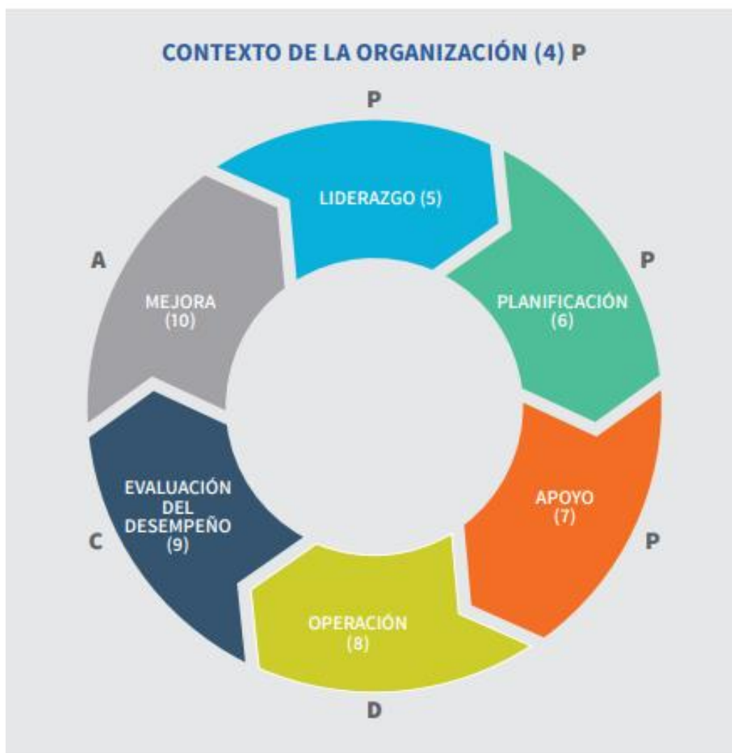
Figura 25 La estructura de alto nivel y el ciclo PDCA (PHVA)
