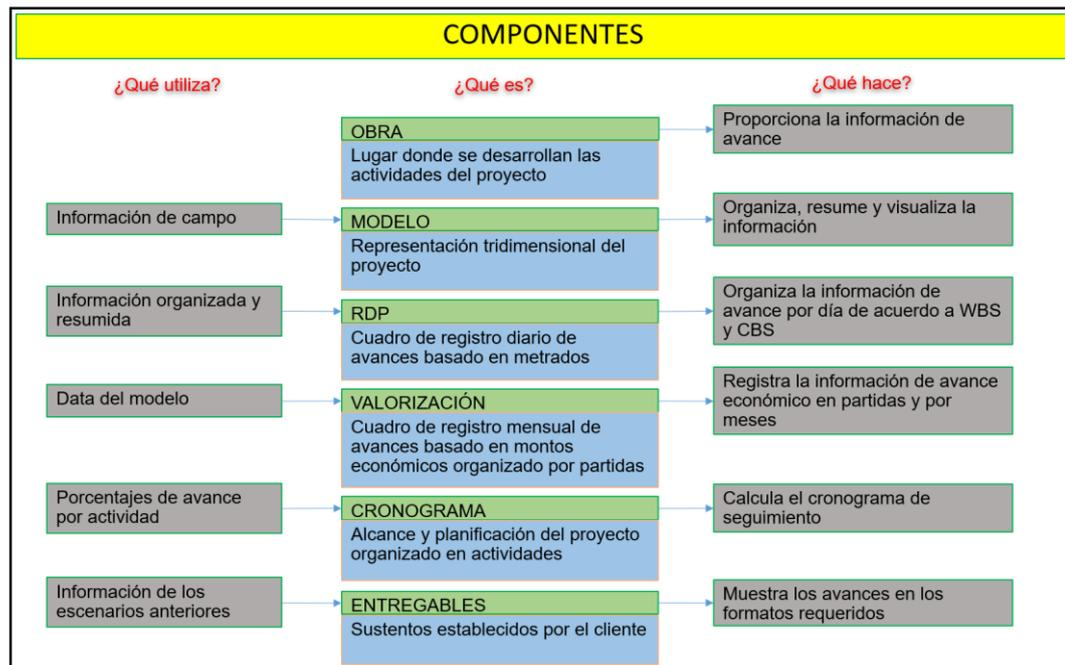
Figura N° 2 Esquema general de los componentes del sistema BIM (elaboración propia).
