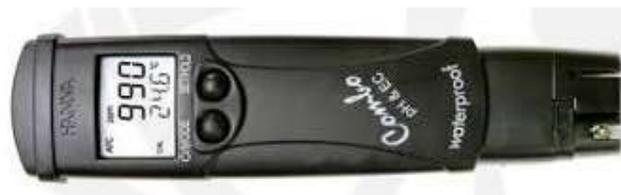
Figura N° 08. Equipo Multi-parámetro para la calidad del agua
