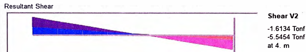
Figura 5-60: Fuerza cortante máxima izquierda del tramo 2. Fuente: SAP2000.
