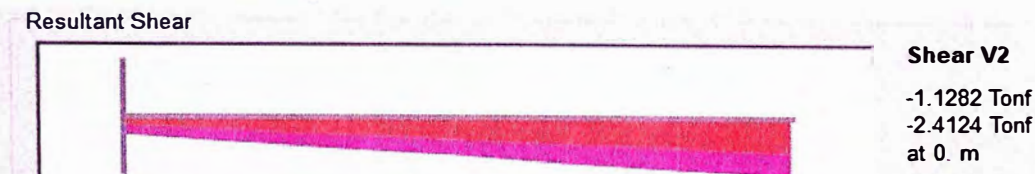
Figura 5-58: Fuerza cortante máxima izquierda del tramo 1. Fuente: SAP2000.
