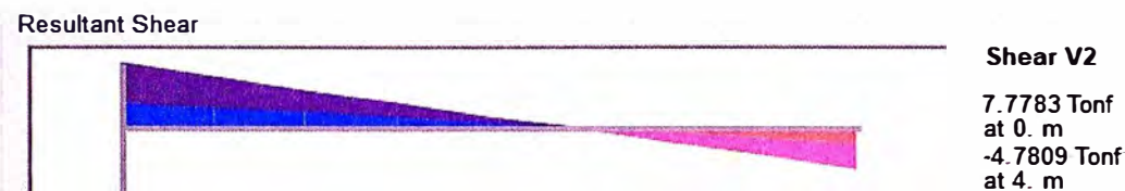
Figura 5-60: Fuerza cortante máxima izquierda del tramo 2. Fuente: SAP2000.
