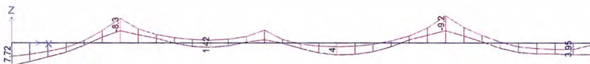
Figura 5-67: Envolvente de momentos flectores. Fuente: SAP2000.
