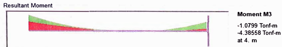
Figura 5-51: Momento máximo negativo izquierdo del tramo 2. Fuente: SAP2000.
