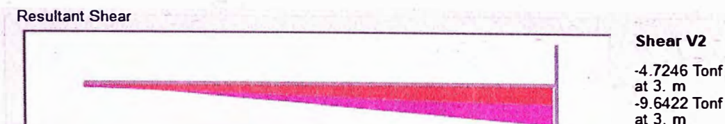
Figura 5-58: Fuerza cortante máxima izquierda del tramo 1. Fuente: SAP2000.
