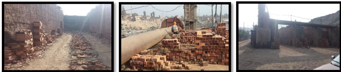
Figura 20. (a) Vista del fondo de bóveda donde van apilados las unidades; (b) Sistema de Ventilación que abastece a las 3 bóvedas de quemado; (c) Vista del horno de quemado en ladrillera semiindustrial “Suyos”.
