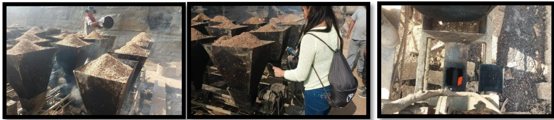
Figura 18. (a) hilera de tolvas llenas de combustible en ladrillera semiindustrial, (b) toma de temperatura a nivel de la entrada del material combustible. (c) punto de visualización y toma de temperaturas de la cámara interior del horno.
