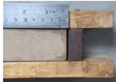
Figura 34. Vista del encogimiento o retracción lineal de la muestra de suelo en la caja. De izquierda a derecha (a) muestra 2-Huachipa, (b) muestra 3- Manchay.
