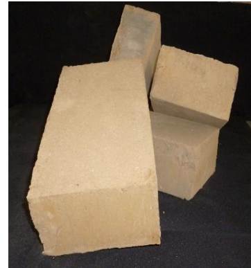
Figura. Molde matriz para fabricación de adobes compactados, Unidades fabricadas, bloques compactados
