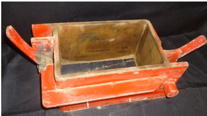
Figura. Molde matriz para fabricación de adobes compactados, Unidades fabricadas, bloques compactados
