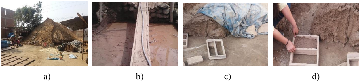
Figura 17. (a) Vista del Taller de fabricación de ladrillos artesanales, con el material suelto disponible, (b) Mezcla de barro con mayor contenido de agua, (c) Mezcla de barro dormido, tapado con plástico denso, (d) Moldeado del barro en gaveras.
