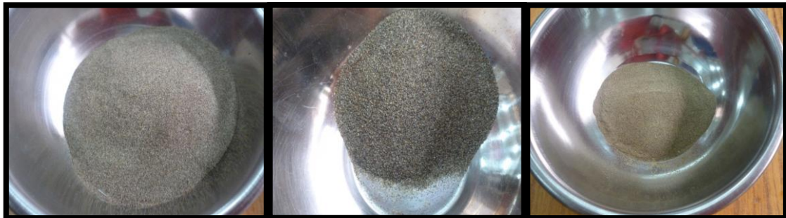
Figura 13. De izquierda a derecha a) Retenido tamiz N o 20; b) Retenido tamiz N o 40; c) Retenido tamiz N o 60.
