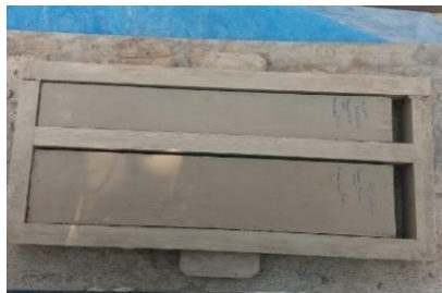
Figura 34. Vista del encogimiento o retracción lineal de la muestra de suelo en la caja. De izquierda a derecha (a) muestra 2-Huachipa, (b) muestra 3- Manchay.
