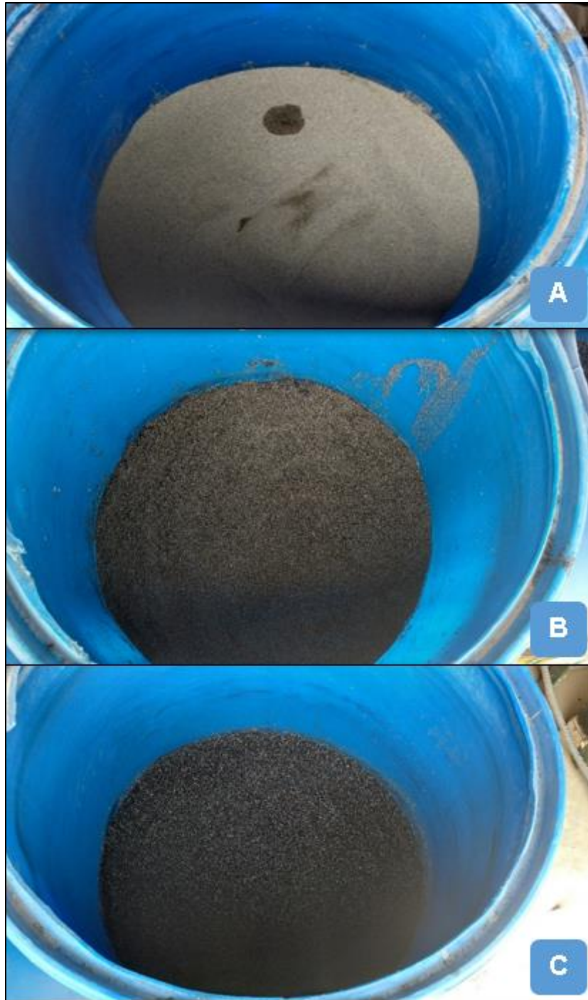
Fotografía N° 20 Cambio del medio filtrante colmatado de los filtros lentos de arena: FLA N°1(A), FLA N°2 (B) y FLA N°3 (C)
