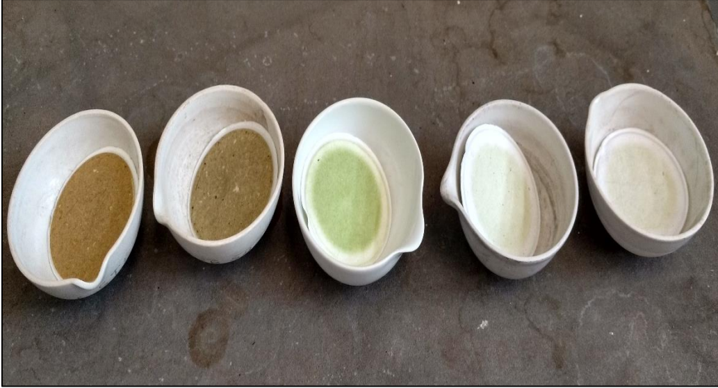
Fotografía N° 21 Retención de los sólidos en suspensión por los filtros de fibra de vidrio, luego de haber sido filtrados con el equipo de filtración al vacío
