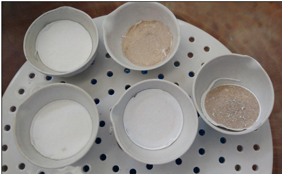
Fotografía N° 22 Capsulas en el disecador luego de haberlas retirado de la estufa a 105 °C.
