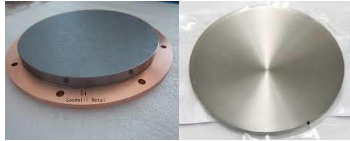
Figura 3.2: Target de silicio y niobio usado para la producción de multicapas.
