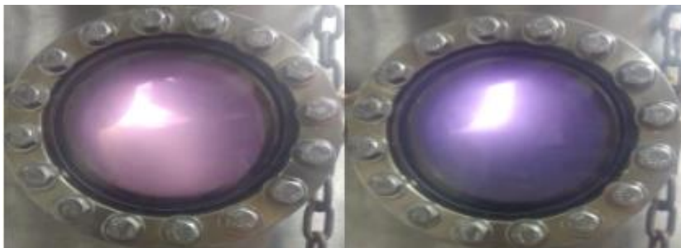
Figura 3.6: Plasma de la deposición de niobio y silicio debido al bombardeo de iones sobre el target.
