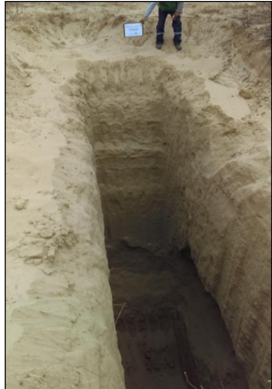
Foto 2. Calicata C-02 de 7.00 m de profundidad, ubicado en el PTAP
