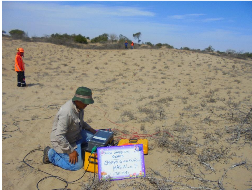
Foto 5. Ensayo MASW 07 en cámara de bombeo CBD - 01
