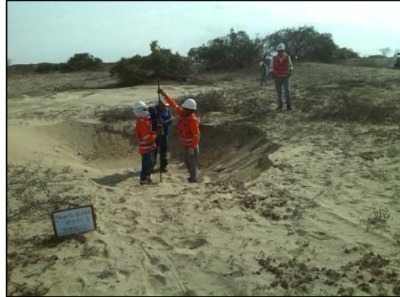
Foto 9. DPL-2 de 2.00 m. de penetración, realizado en un calicata de 1.00 m de profundidad, ubicado en REP 1
