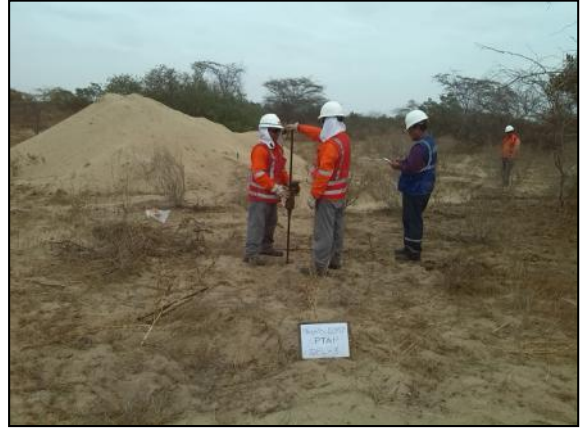
Foto 6. DPL-3 de 3.00 m. de penetración, ubicado en PTAP
