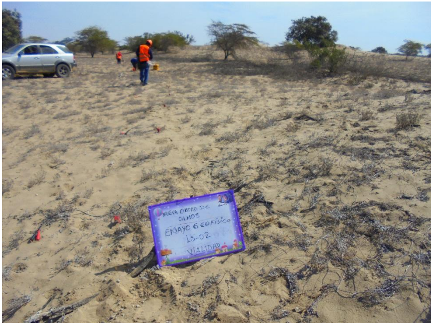
Foto 10. Ensayo de refracción sísmica vialidad LS-02
