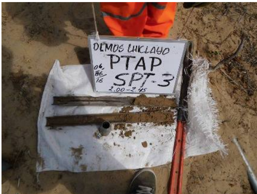
Muestra extraída del Ensayo de Penetración Estándar SPT-3/PTAP (Planta de Tratamiento de Agua Potable).
