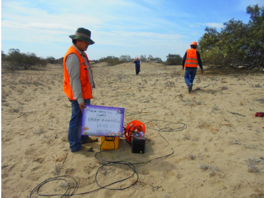
Foto 9. Ensayo de refracción sísmica vialidad LS-01
