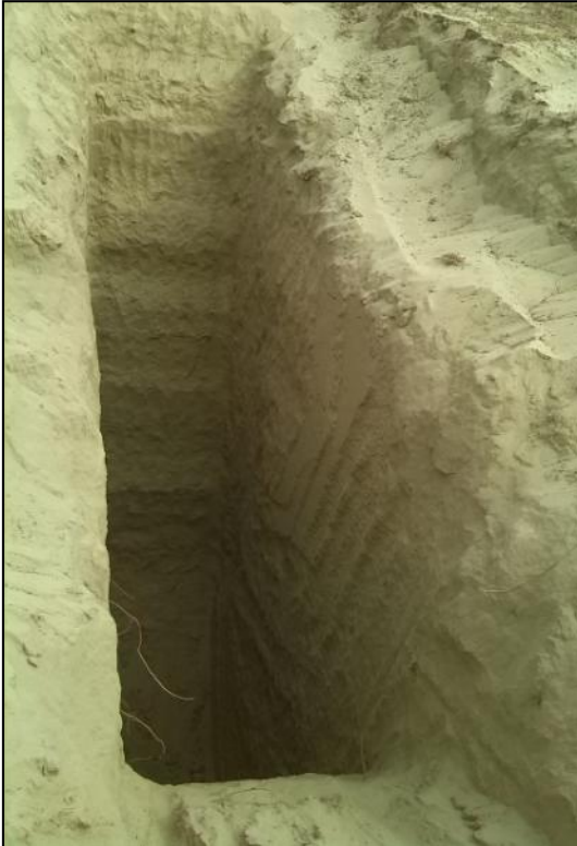
Foto 1. Calicata C-01 de 7.00 m de profundidad, ubicado en el PTAP
