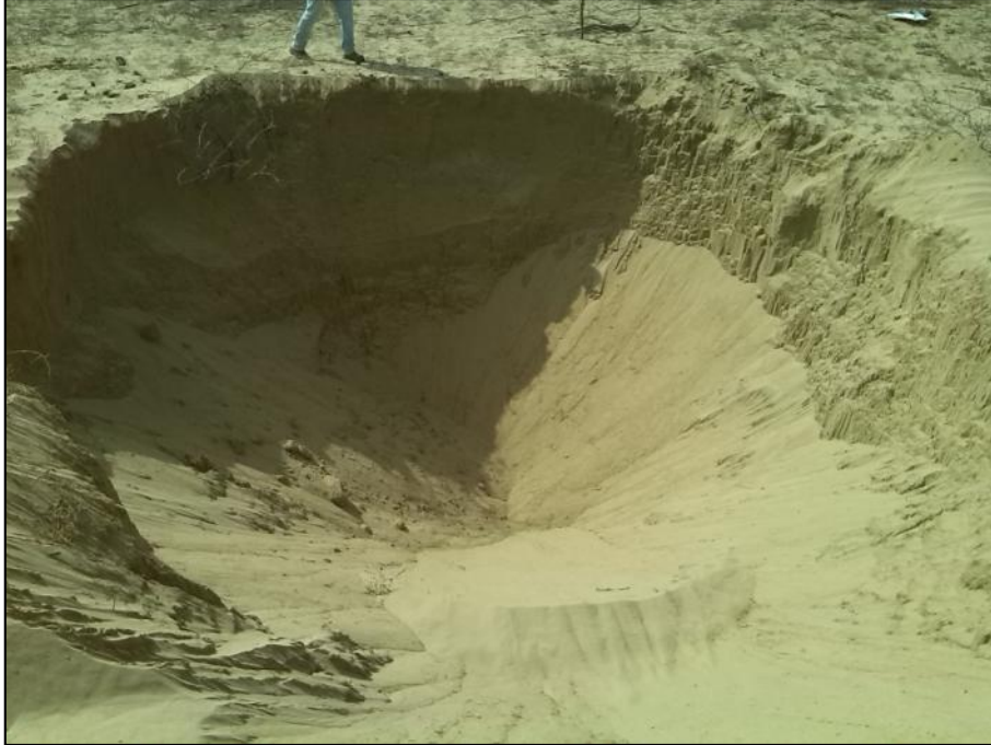
Foto 3. Calicata C-01 de 4.00 m. de profundidad, ubicado en el Reservorio 1. Las paredes de la calicata se colapsan, e impiden seguir excavando.
