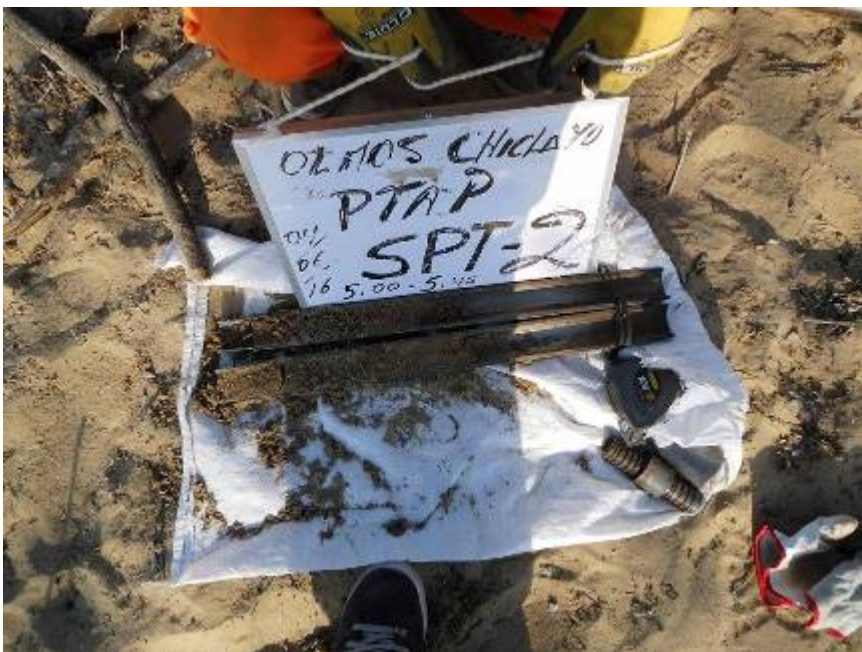
Muestra extraída del Ensayo de Penetración Estándar SPT-2/PTAP (Planta de Tratamiento de Agua Potable).
