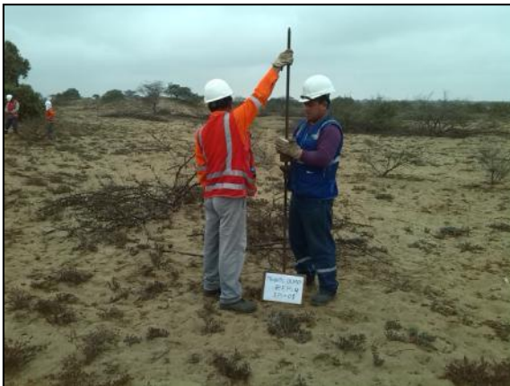
Foto 10. DPL-1 de 5.20 m. de penetración, ubicado en el REP 4
