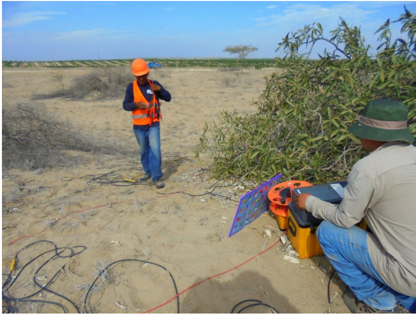
Foto 11. Ensayo de refracción sísmica vialidad LS-03
