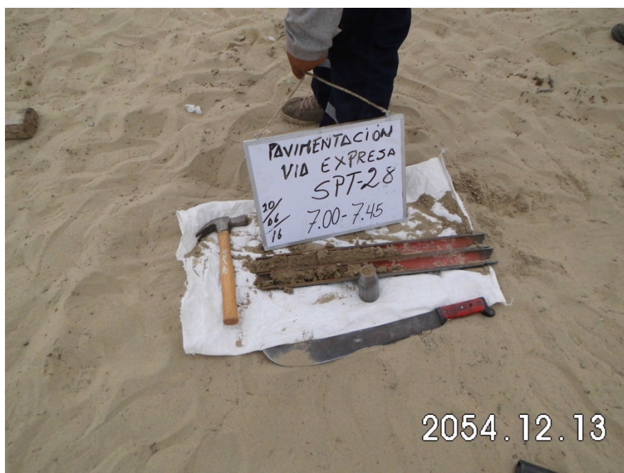
Muestra extraída del Ensayo de Penetración Estándar SPT-28/Eje B2 - Eje D5.
