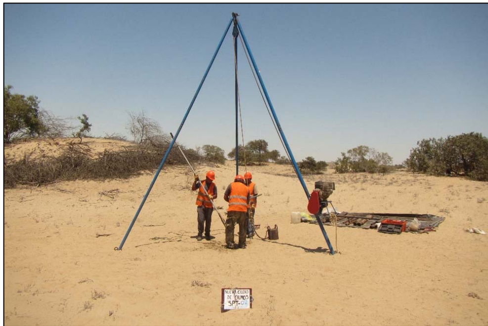
Foto N°3.1. Ensayo de SPT en la zona de exploración (Fuente propia).
