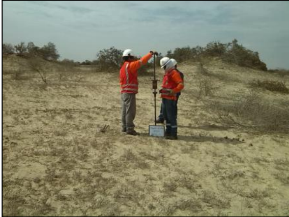
Foto 8. DPL-1 de 3.70 m. de penetración, ubicado en el REP 1
