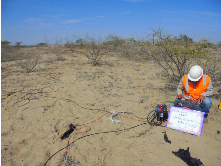
Foto 7. Ensayo MASW 08 en cámara de bombeo CBD – 02.
