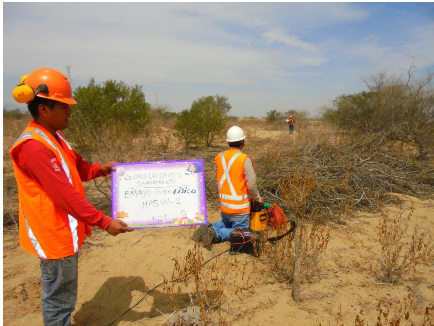
Foto 2. Ensayo MASW - 02 en planta de tratamiento de agua potable PTAP.
