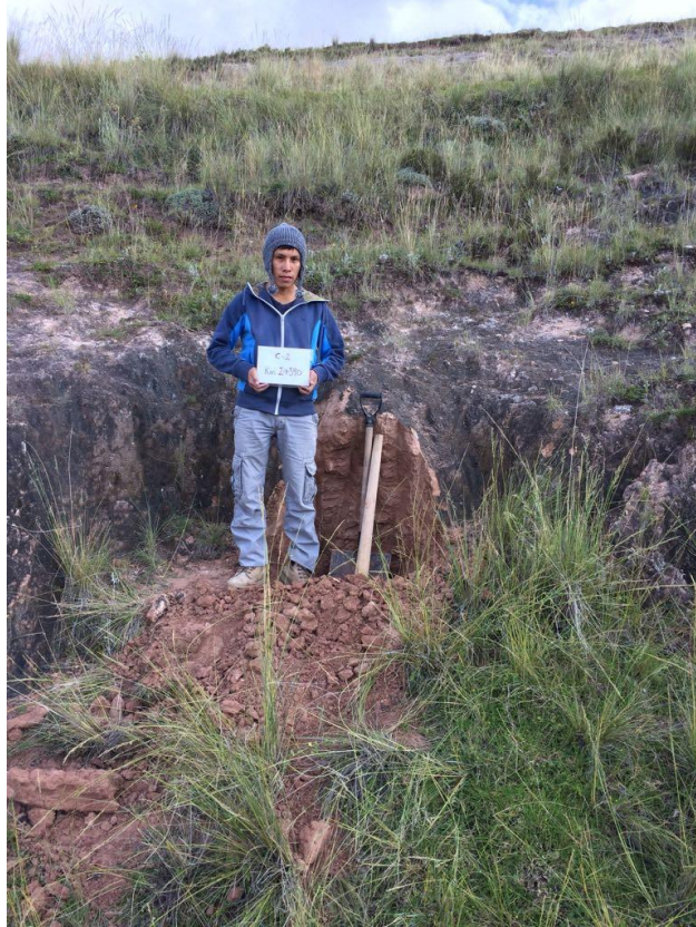
Figura N° 16: Tercera calicata - extracción de muestra de suelo
