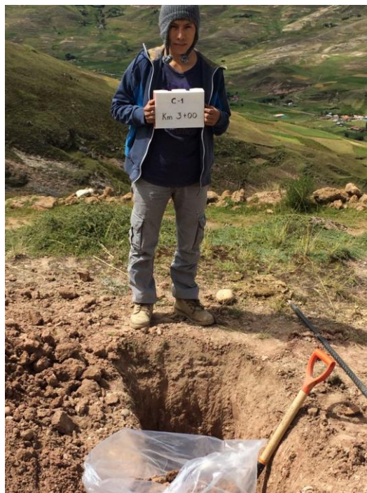
Figura N° 14: Primera calicata realizada - extracción de muestra de suelo
