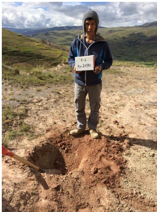
Figura N° 15: Segunda calicata - extracción de muestra de suelo
