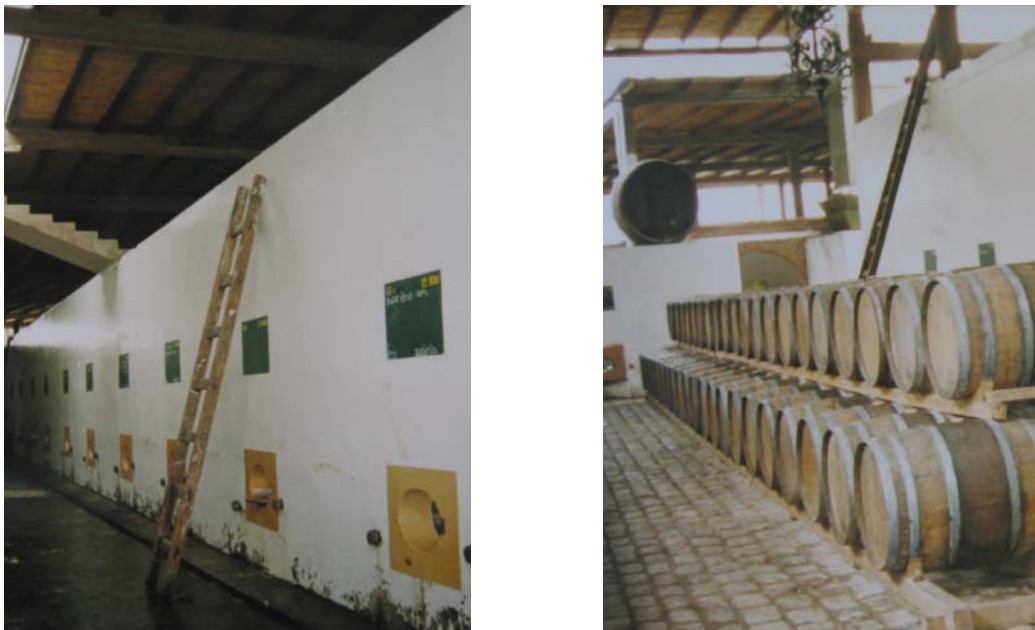
Figura 1.3. Tanques de concreto y Barricas de roble, para el almacenamiento y reposo de mostos.
