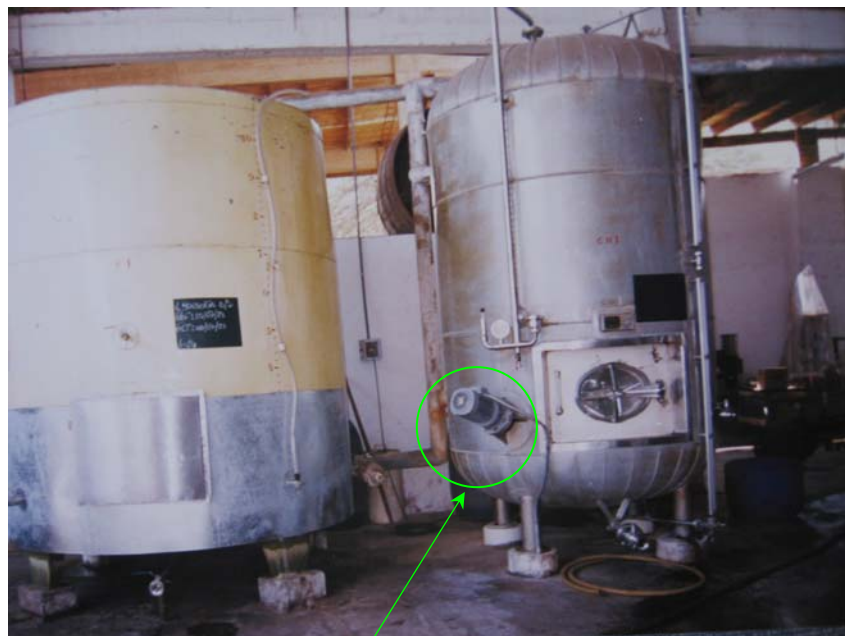
Figura 1.10. Tanque chato y tanque ovalado con motor removedor (REM) de mosto.
