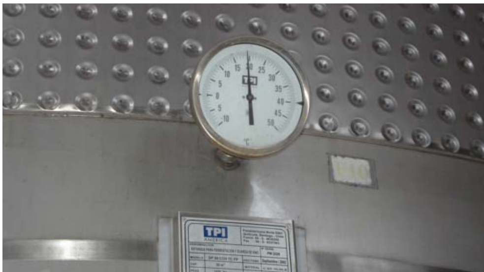
Figura 1.8. Termómetro para medición de temperatura en tanque de Fermentación.
