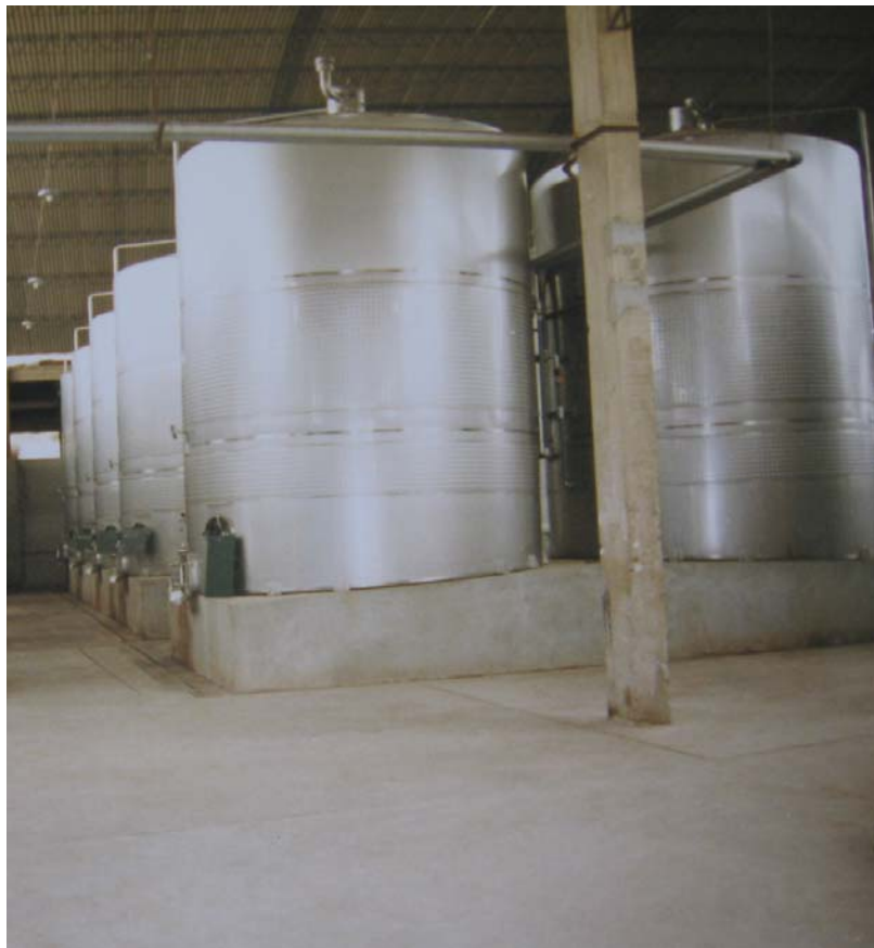
Figura 1.2. Tanques de acero inoxidable de 50,000 litros de capacidad, para el Proceso de Fermentación.
