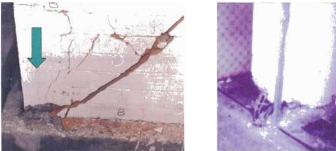
Figura 4.19.- Aplastamiento típico del talón por flexo compresión en el muro.
