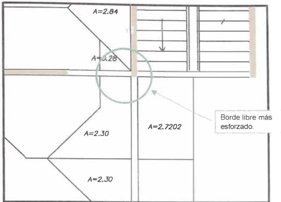
FIG.3 DETALLE EXTREMO MURO Y2
