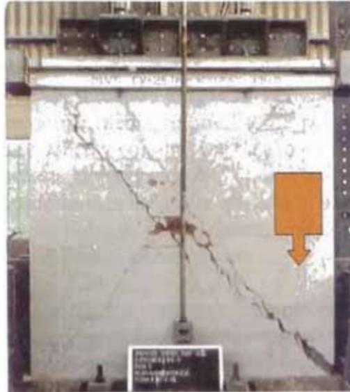
Figura 4.22.- Trituración de la zona central del muro y aplastamiento de la columna de confinamiento.
