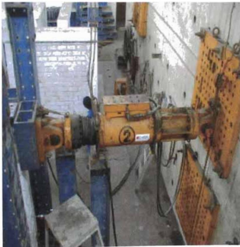
Figura 6.3.- Actuador Horizontal aplicando carga cíclica lateral al muro típico.
