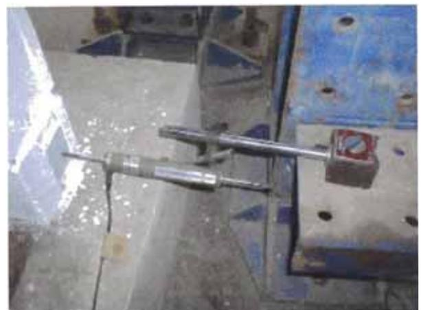
Figura 6.5.- Transductores de desplazamiento empleados CH 103, CH 104.
