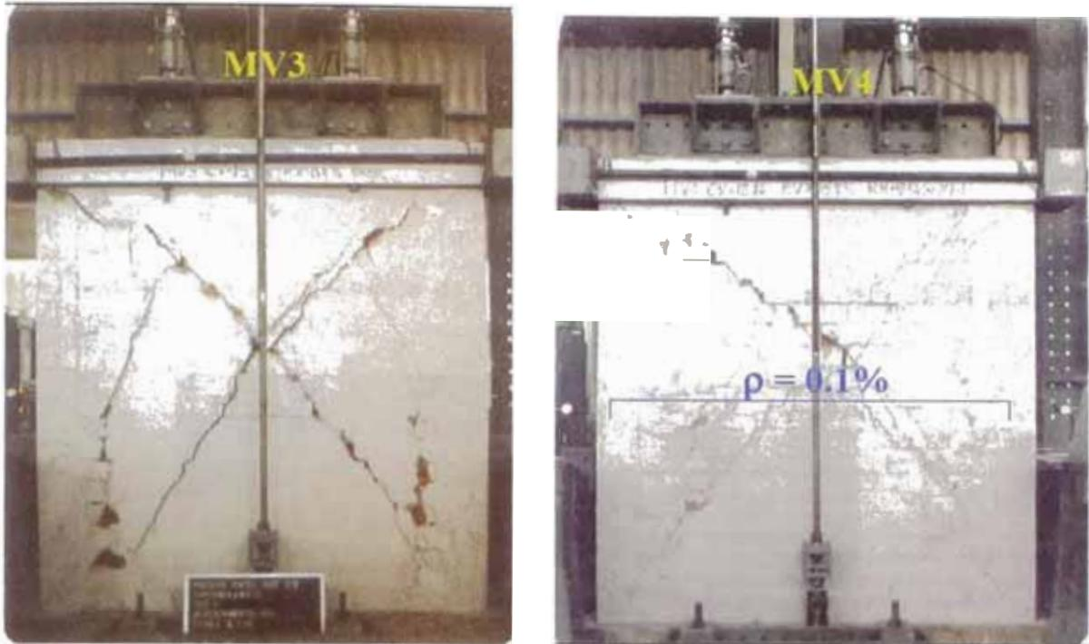
Figura 4.13.- Vistas de dos muros sujetos a la misma carga axial de 9% de  $f'm$  y el mismo desplazamiento lateral 17.5mm. El de la izquierda no tiene refuerzo horizontal y el de la derecha si tiene refuerzo horizontal con una cuantía de 0.1%. (Ensayo realizado por el Ingeniero Angel San Bartolomé)
