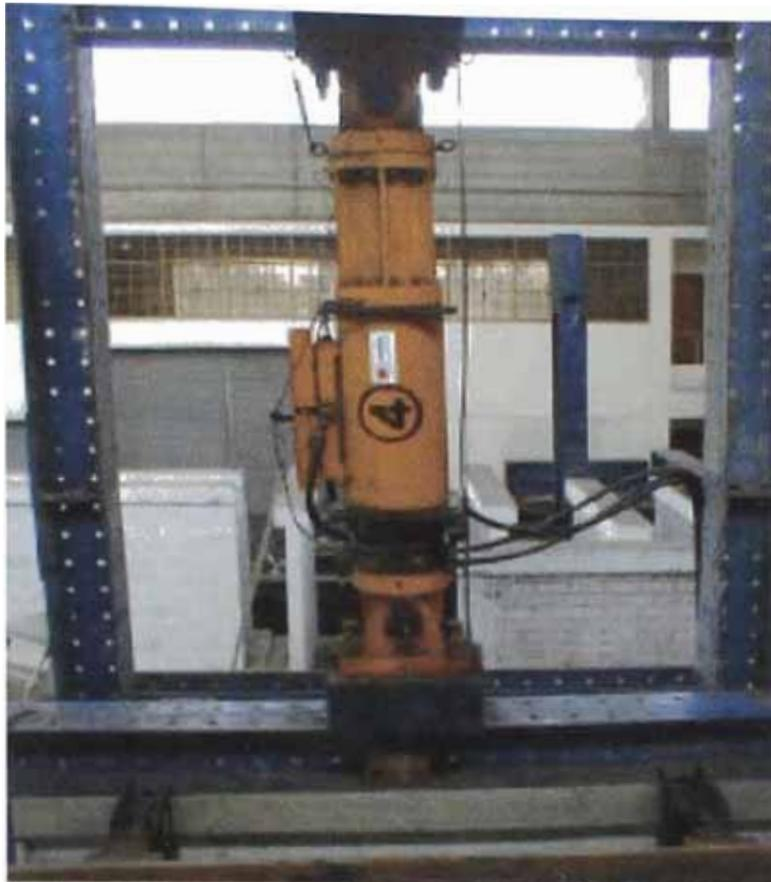
Figura 6.2.- Actuador Vertical aplicando carga constante de confinamiento con distribución uniforme en la parte superior del muro típico.
