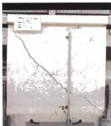
Figura 4.10.- Propagación de las grietas del muro hacia los extremos de las columnas de confinamiento.
