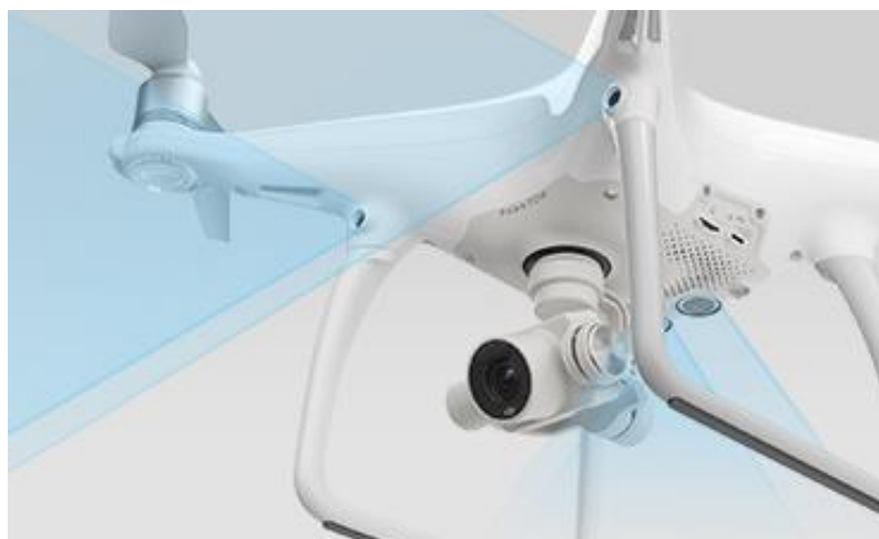
Figura 4. 13 sistema anticolisión Phantom 4 Fuente DJI
