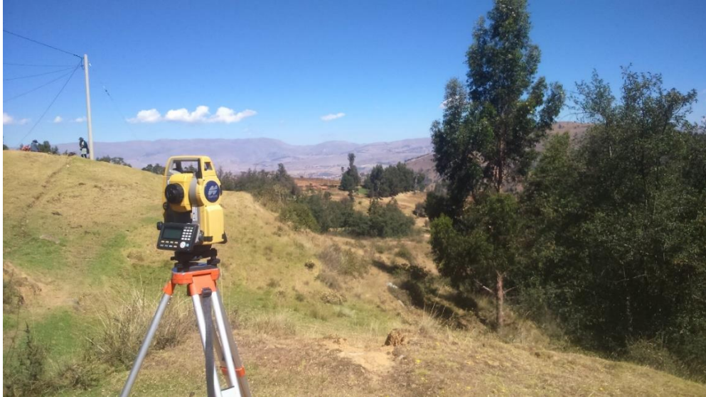
Fotografía 1. 1 toma de datos en campo con estación total Fuente Elaboración Propia
