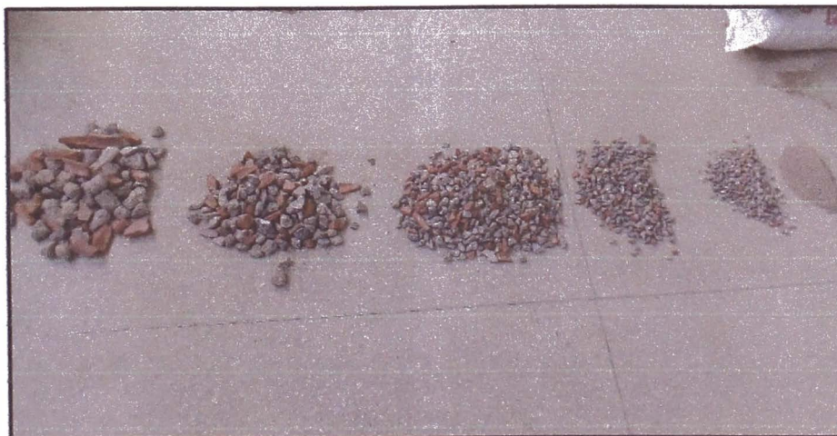
Foto N°11: Análisis Granulométrico del Agregado Grueso Reciclado.
