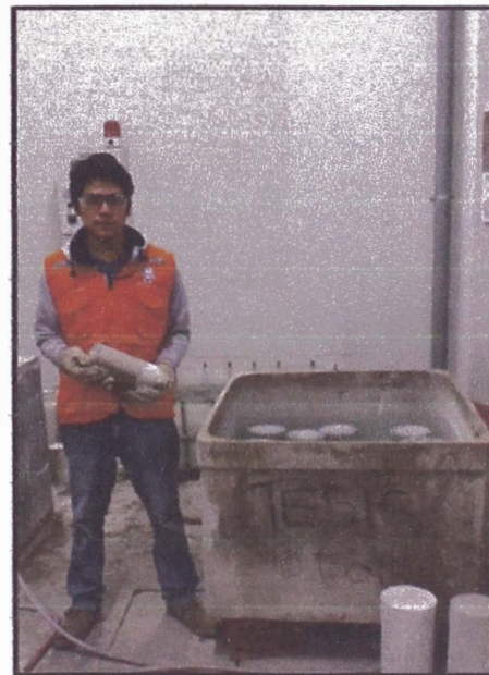
Foto N°26 y 27: Llenado y curado de probetas de concreto.
