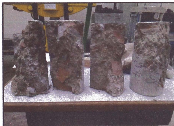
Foto N°31: Muestras de probetas de concreto combinado ensayadas.
