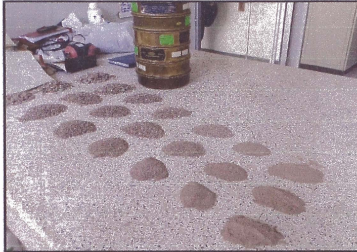
Foto N°08: Análisis Granulométrico del Agregado Fino Reciclado.
