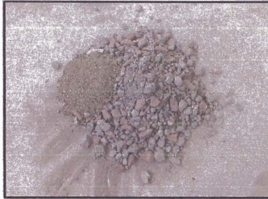
Foto N°12: Combinación de A. Fino Patrón + A. Global Reciclado.
