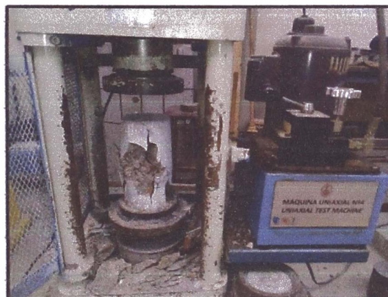
Foto N°30: Probeta de concreto combinado después del ensayo de resistencia a la compresión axial.
