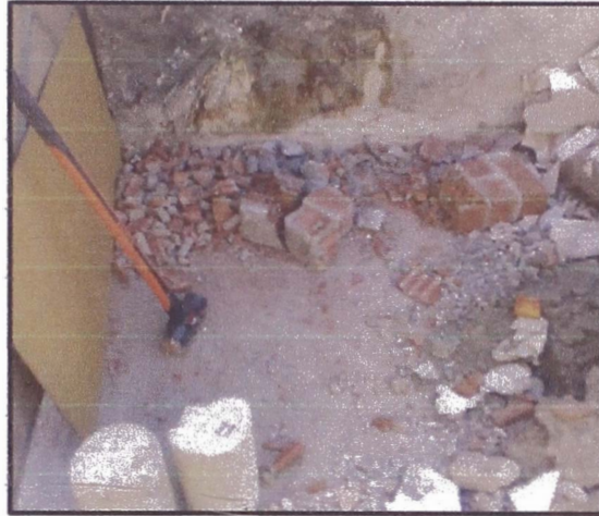
Foto N°04: Trituración del RCD de origen pétreo para la investigación.
