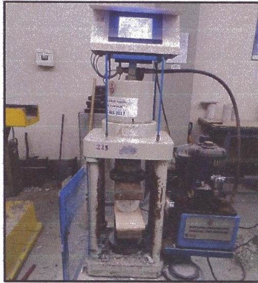
Foto N°32: Probeta de concreto sometida al ensayo de resistencia a la tracción por compresión diametral.
