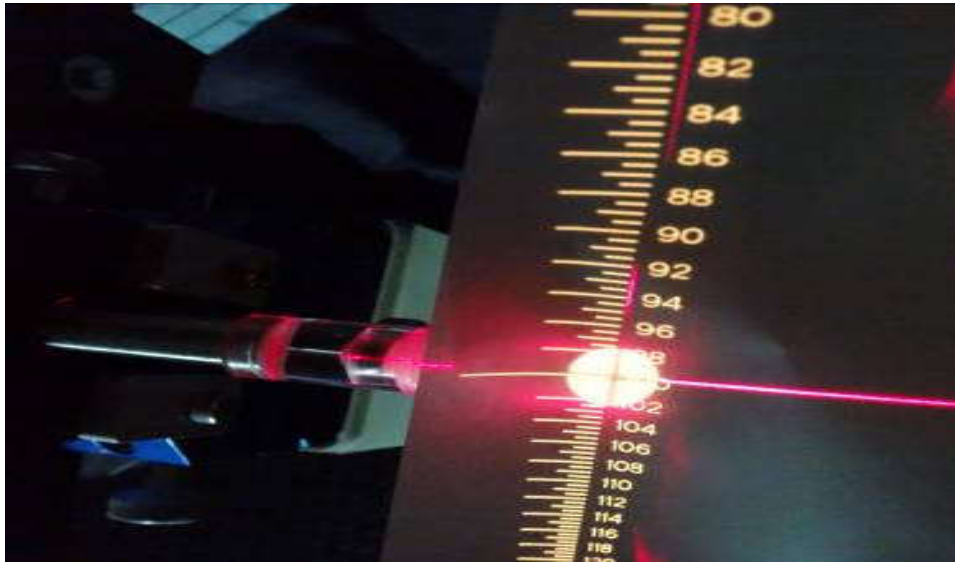
Figura 28. Haz colimado para el Test de Winston –Lutz.
