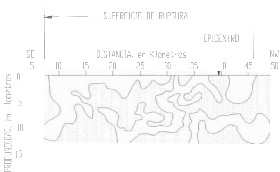
FIGURA 6.1 Esquema de funciones de Green una falla dividida en N pedazos. Las diferencias en las funciones de Green para los diferentes pedazos se deben a las diferencias en la profundidad focal, distancia al epicentro y la estructura geológica a lo largo de la ruta del sitio a la fuente. Una vez que las funciones de Green han sido determinados, los acelerogramas del sitio pueden ser simulados fácilmente para una variedad de modelos de ruptura de falla y funciones de deslizamiento.
