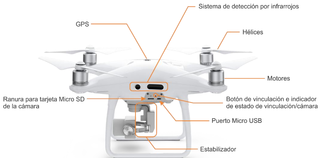
Figura N° 23 Diagrama de las partes de la aeronave Phantom 4 Pro en una vista lateral.
