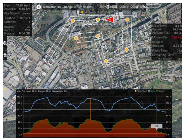
Figura N° 30 Captura de pantalla mostrándose un plan de vuelo en el software Map Pilot, donde se está programando al RPA para volar a una altura constante de 164m sobre el terreno.
