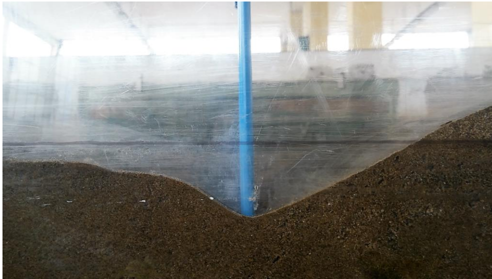
Fotografía N° D.9. Perfil de hoyo de socavación alrededor del espigón permeable luego del paso de flujo. La línea trazada de color negro representa el nivel de lecho inicial. Se puede apreciar socavación aguas arriba y agua abajo del espigón de prueba y el efecto de acorazamiento de lecho, mostrándose libre de las partículas mas finas en las capas superiores. Las características del talud, profundidad y ancho del hoyo varía con la permeabilidad y orientación del espigón de prueba. El sentido de flujo en la fotografía es de izquierda a derecha.
