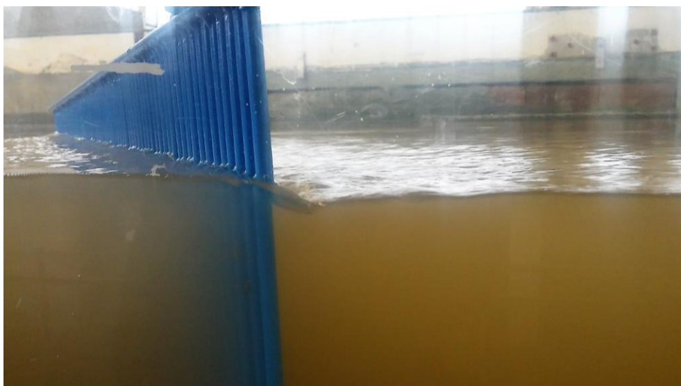
Fotografía N° D.6. Desnivel de flujo aguas arriba y aguas abajo del cuerpo del espigón. Se aprecia el efecto de pérdida de energía local provocado por el cuerpo permeable del espigón. Generalmente se obtuvo una pérdida de energía de 2 cm, disminuyendo con la permeabilidad del espigón. El sentido de flujo en la fotografía es de izquierda a derecha.
