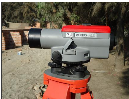
Figura N° 3.9 Nivel topográfico. Fuente: Propia
