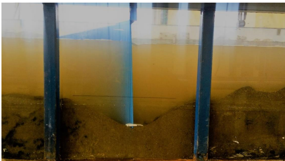
Fotografía N° D.8. Perfil de hoyo de socavación alrededor del espigón permeable durante el paso de flujo. La línea trazada de color negro representa el nivel de lecho inicial. Se puede apreciar un hoyo de socavación en forma de "V" con pendiente 1H:1V y un ancho promedio de 15 cm. Las características del talud, profundidad y ancho del hoyo varía con la permeabilidad y orientación del espigón de prueba. Aguas abajo del espigón se aprecia la región de sedimentación con pequeños rizados superpuestos. El sentido de flujo en la fotografía es de izquierda a derecha.
