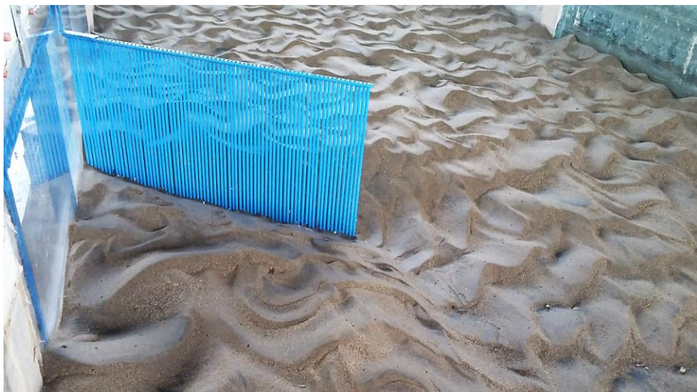
Fotografía N° D.10. Formas de fondo alrededor del espigón permeable. Se puede apreciar una variedad de formas de fondo alrededor del cuerpo del espigón. Aguas arriba se observa la zona de contracción de rizos y aguas abajo se observa la zona de sedimentación. El sentido de flujo en la fotografía es de arriba hacia abajo.
