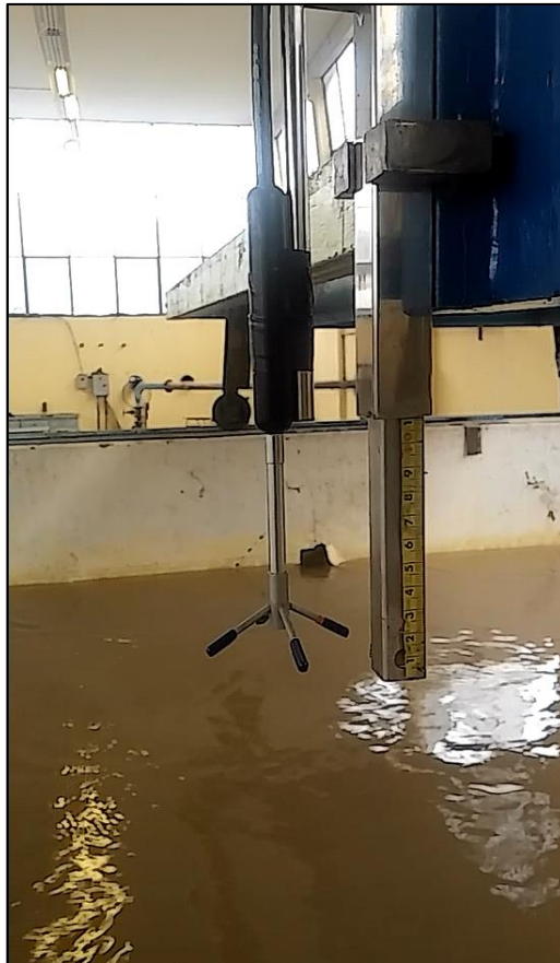
Figura N° 3.29 Medición de tirantes de flujo alrededor del espigón. Fuente: Propia
