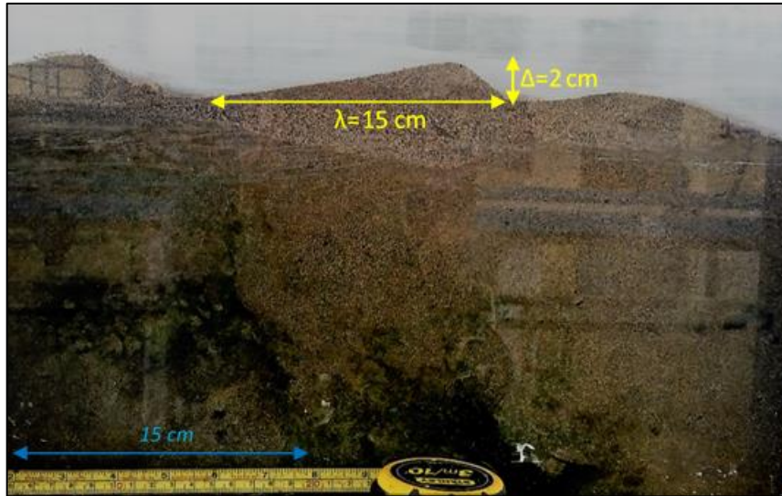
Figura N° 5.20 Dimensiones de forma de fondo típica. Fuente: Propia
