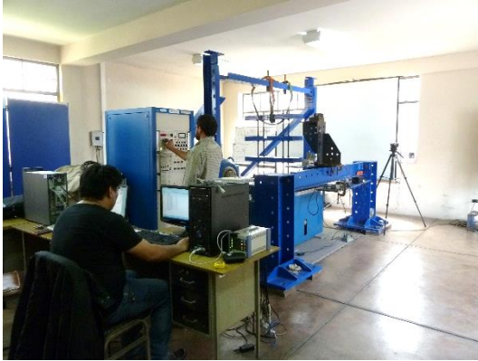
Figura N° B.1 Ensayo dinámico sobre mesa vibradora.
