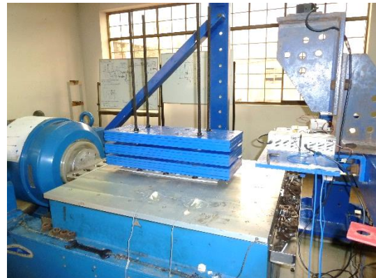
Figura N° B.4 Calibración de mesa vibradora con aprox. 360 kgf.
