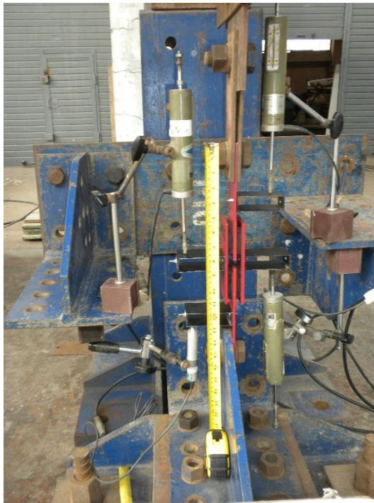
Figura N° A.13 Ensayo de módulo de corte MC-02.
