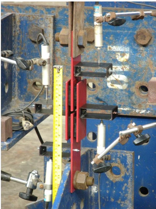
Figura N° A.11 Ensayo de módulo de corte MC-01.
