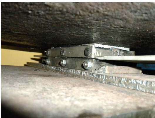
Figura N° A.5 Espécimen durante proceso de vulcanizado.
