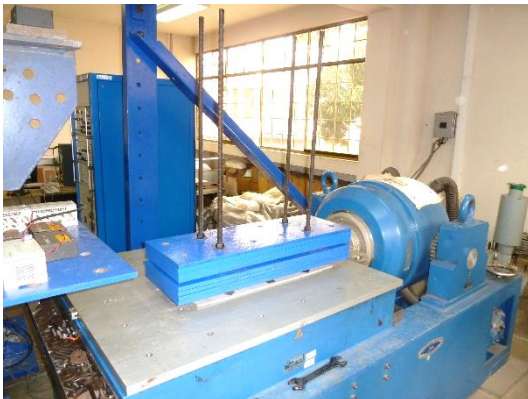
Figura N° B.3 Calibración de mesa vibradora con aprox. 240 kgf.
