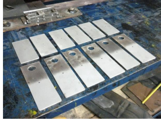
Figura N° A.2 Láminas de acero arenadas.
