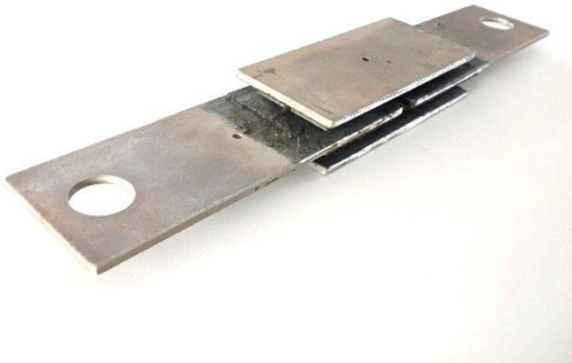
Figura N° A.7 Espécimen después del vulcanizado.
