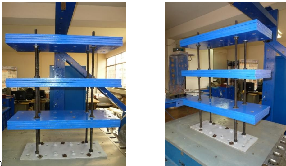
Figura N° 4.11 Especímen de tres pisos a escala 1/10 con base fija (Fuente: Reyna R., 2013)
