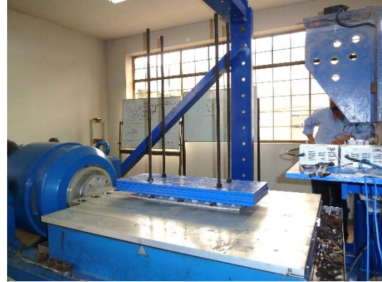
Figura N° B.2 Calibración de mesa vibradora con aprox. 120 kgf.
