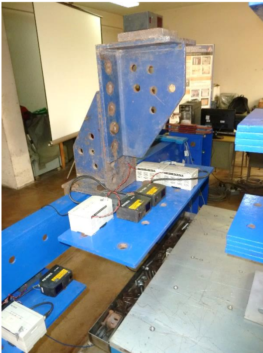
Figura N° B.11 Transductores de desplazamiento laser.
