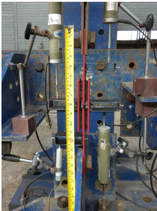
Figura N° A.15 Ensayo de módulo de corte MC-03.
