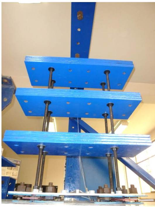
Figura N° B.9 Espécimen con base aislada.
