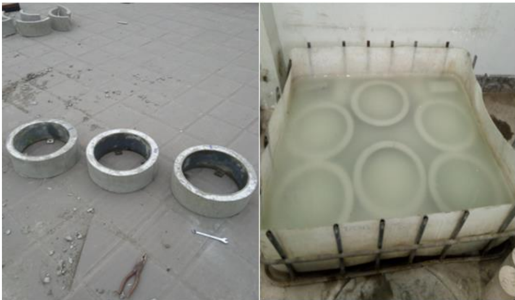
Figura N° F.0.24. Desmoldado y curado de los especímenes del anillo de contracción.
