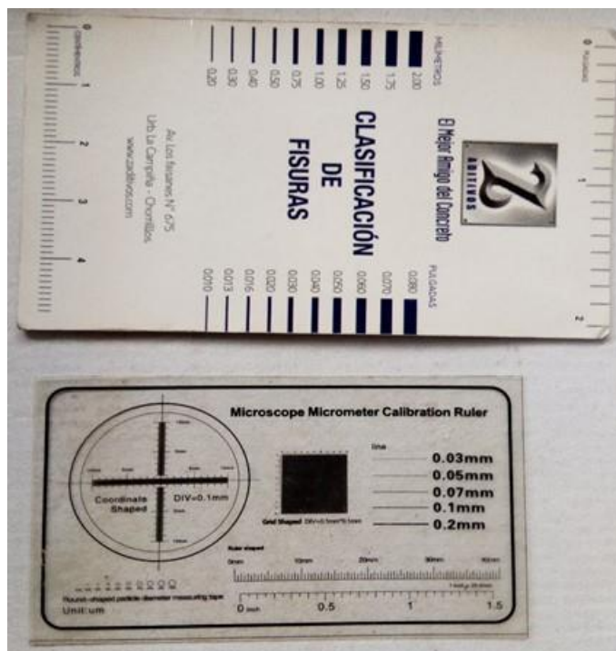
Figura N° 8.2. Fisurométros usados para medir longitud y ancho de fisuras
