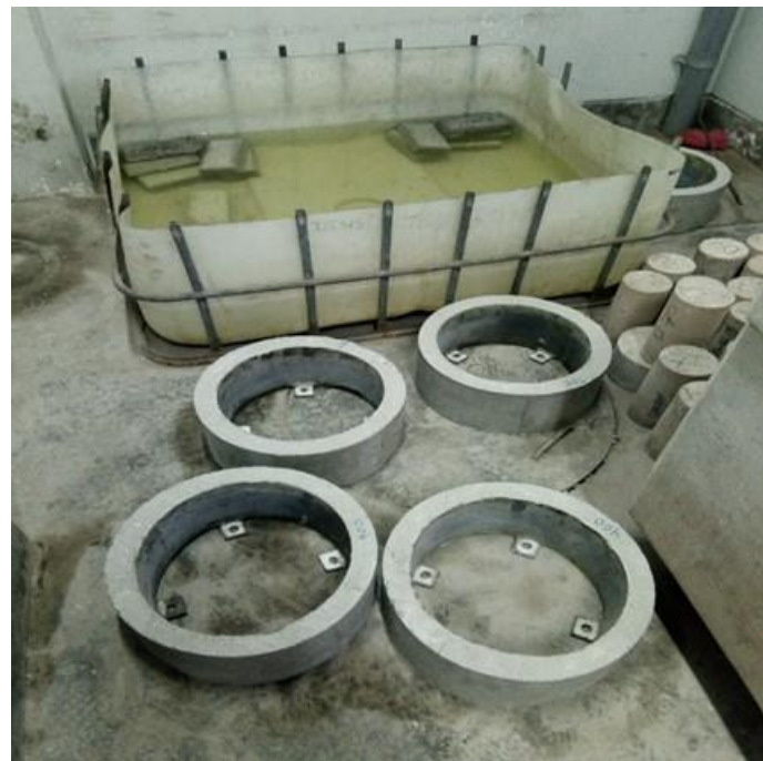
Figura N° 7.4. Desmoldado del anillo exterior y la base para el curado de la muestra
