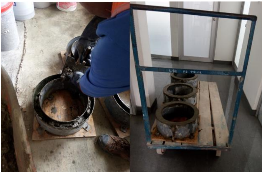
Figura N° F.0.22. Llenado y traslado de los moldes de anillo de contracción a la azotea de LEM.
