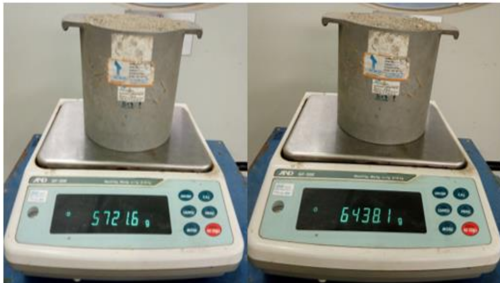
Figura N°F.0.4. PUS (izquierda) y PUC (derecha) del agregado fino
