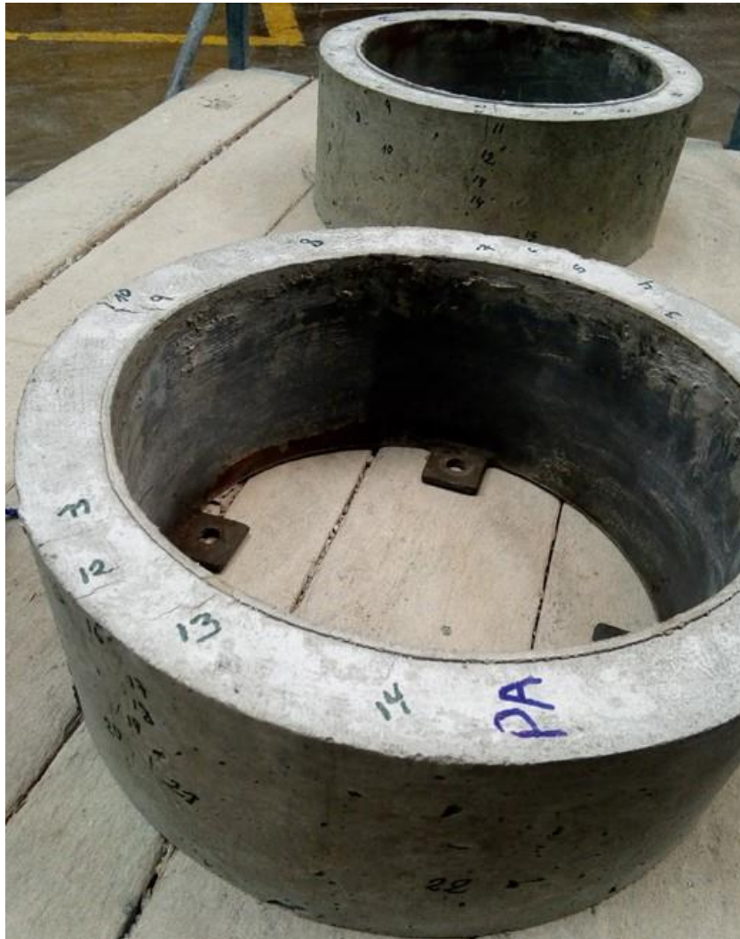
Figura N° 8.1. Fisuras superficiales y laterales en la muestra del concreto patrón en el anillo de contracción.
