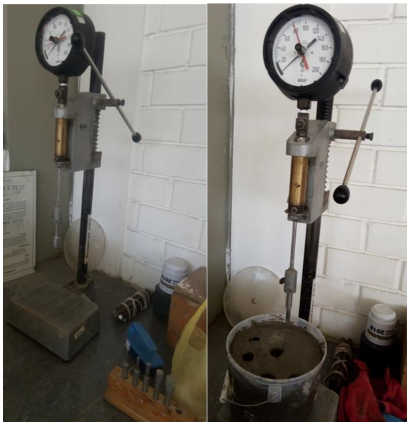
Figura N° F.0.16. Ensayo del tiempo de fragua.
