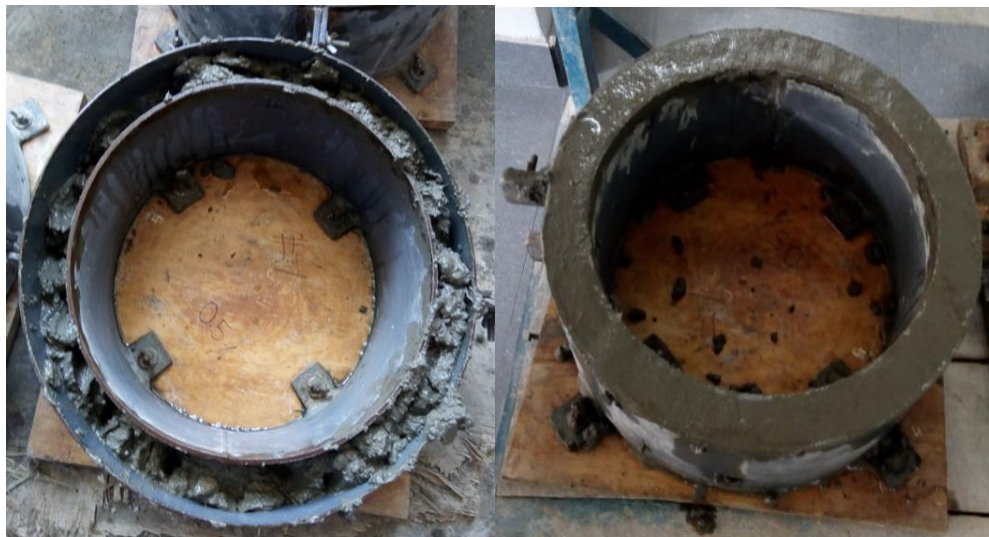
Figura N° 7.2. Anillo de contracción (Izquierda: proceso de llenado; Derecha: lleno de concreto)
