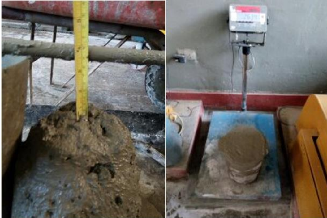
Figura N° F.0.11. Ensayo de asentamiento (izquierda) y ensayo de peso unitario (derecha).
