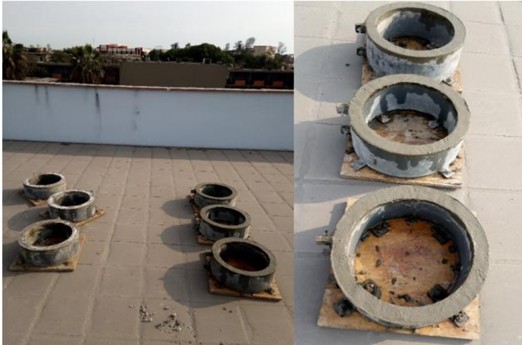
Figura N° F.0.23. Exposición al Sol de los moldes de anillo de contracción.
