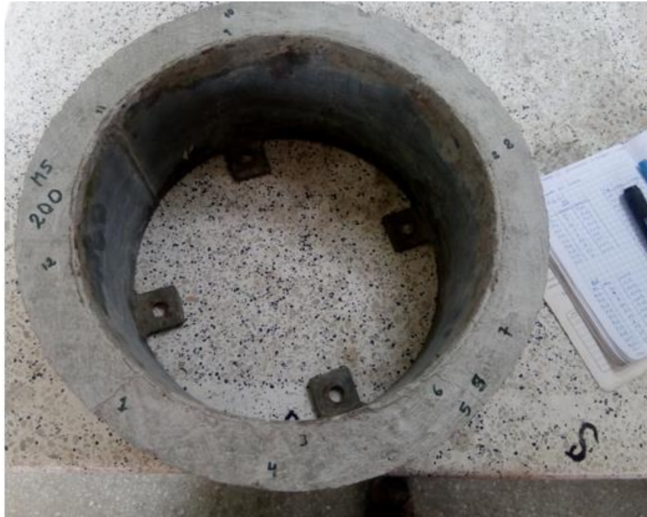
Figura N° F.0.25. Conteo de fisuras superficiales
