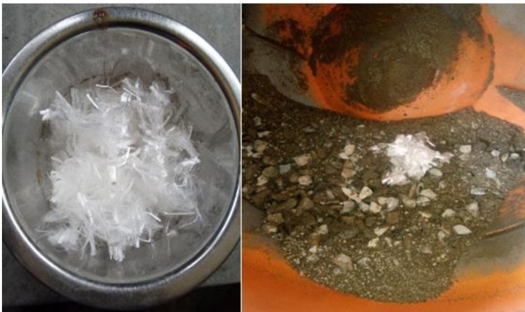
Figura N° F.0.10. Preparación del concreto con fibra ultrafina
