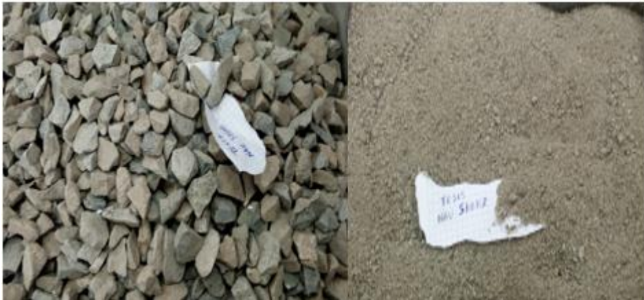
Figura N°F.0.1. Agregado grueso (izquierda) agregado fino (derecha)
