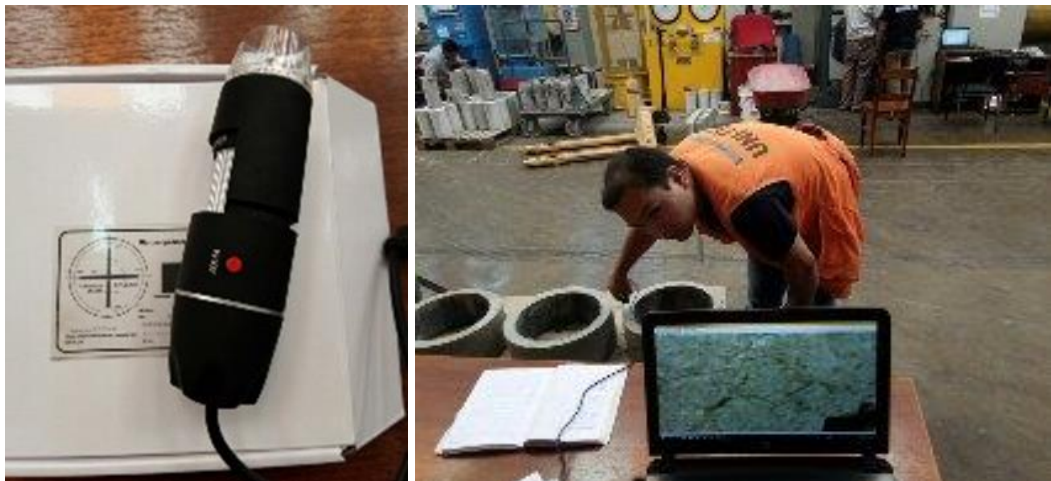
Figura N° 7.5. Microscopio AMCap para visualizar fisuras.
