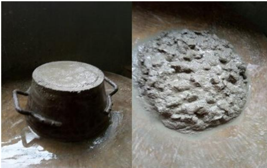
Figura N° F.0.12. Ensayo de fluidez del concreto
