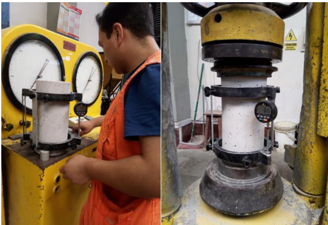
Figura N° F.0.19. Montaje del equipo para el ensayo del módulo elástico.
