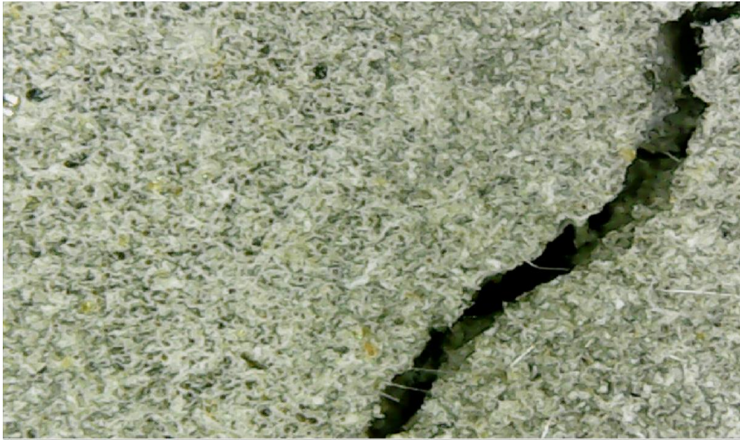
Figura N° F.0.29. Fisura superficial del concreto con fibra ultrafina 400 g/m 3 , captada con el microscopio AMCap
