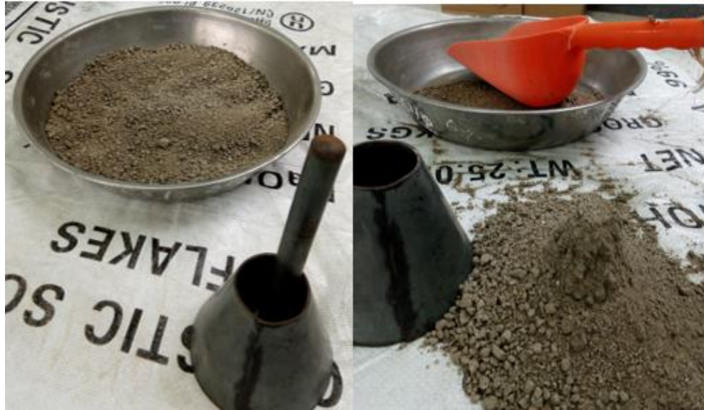
Figura N° F.0.7. Ensayo para determinar la condición saturada superficialmente seca de la arena
