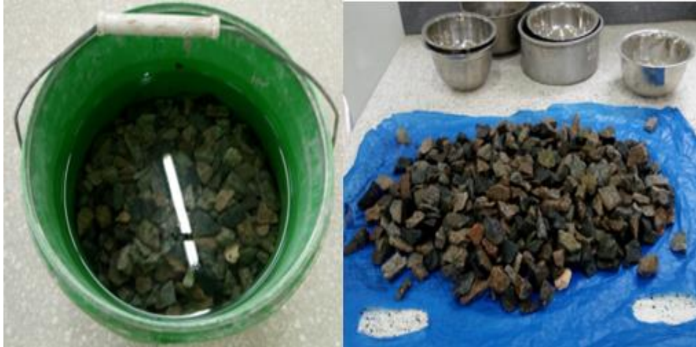
Figura N° F.0.5. Saturado del agregado grueso para el ensayo del peso específico.
