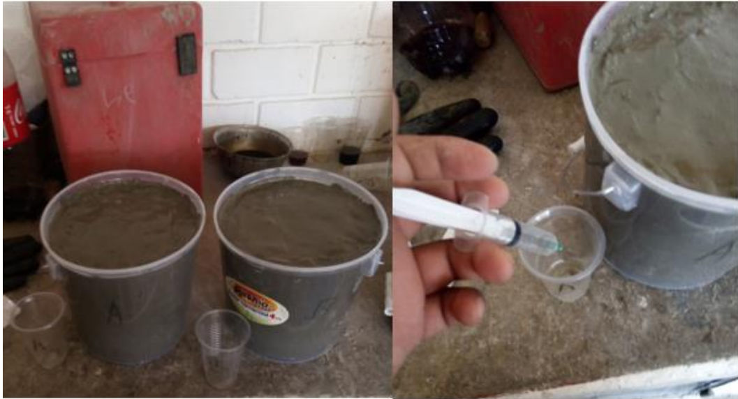
Figura N° F.0.15. Ensayo de exudación.
