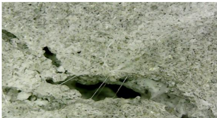
Figura N° 7.10. Fisura superficial del concreto con fibra ultrafina 200 g/m 3 , captada con el microscopio AMCap
