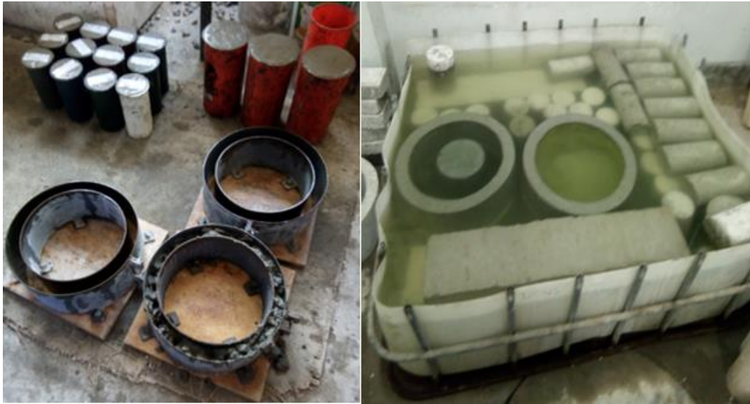
Figura N° F.0.17. Elaboración y curado de probetas y anillos de contracción.
