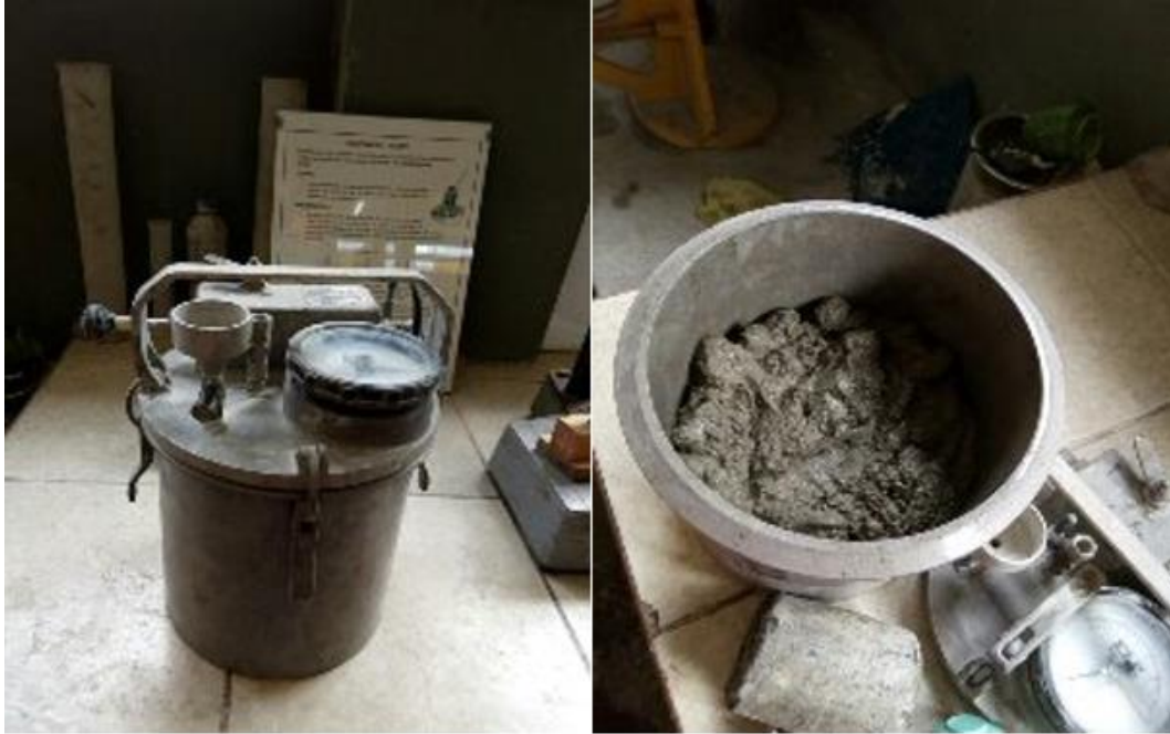
Figura N° F.0.13. Ensayo del contenido de aire con olla Washington.
