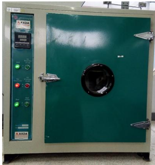
Figura N°F.0.2. Horno usado para secar los agregados
