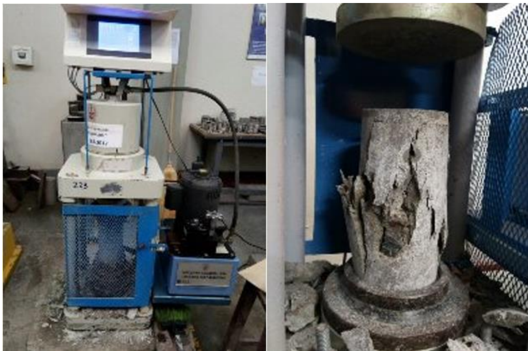
Figura N° F.0.18. Ensayo de la resistencia a la compresión.
