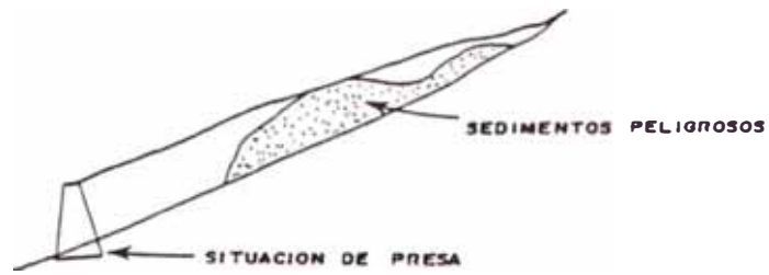
fig. 3.5 Presa Para coger sedimentos
