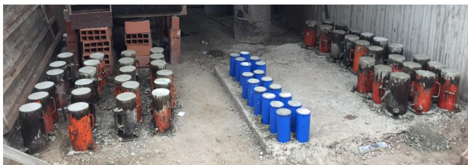
Figura N° 28 Moldes de probetas de concreto extraídas en obra
