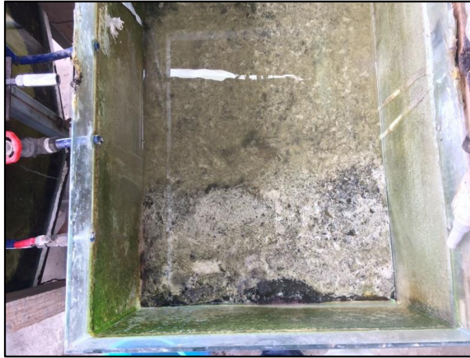
Figura 24-Lodos depositados en la primera etapa
