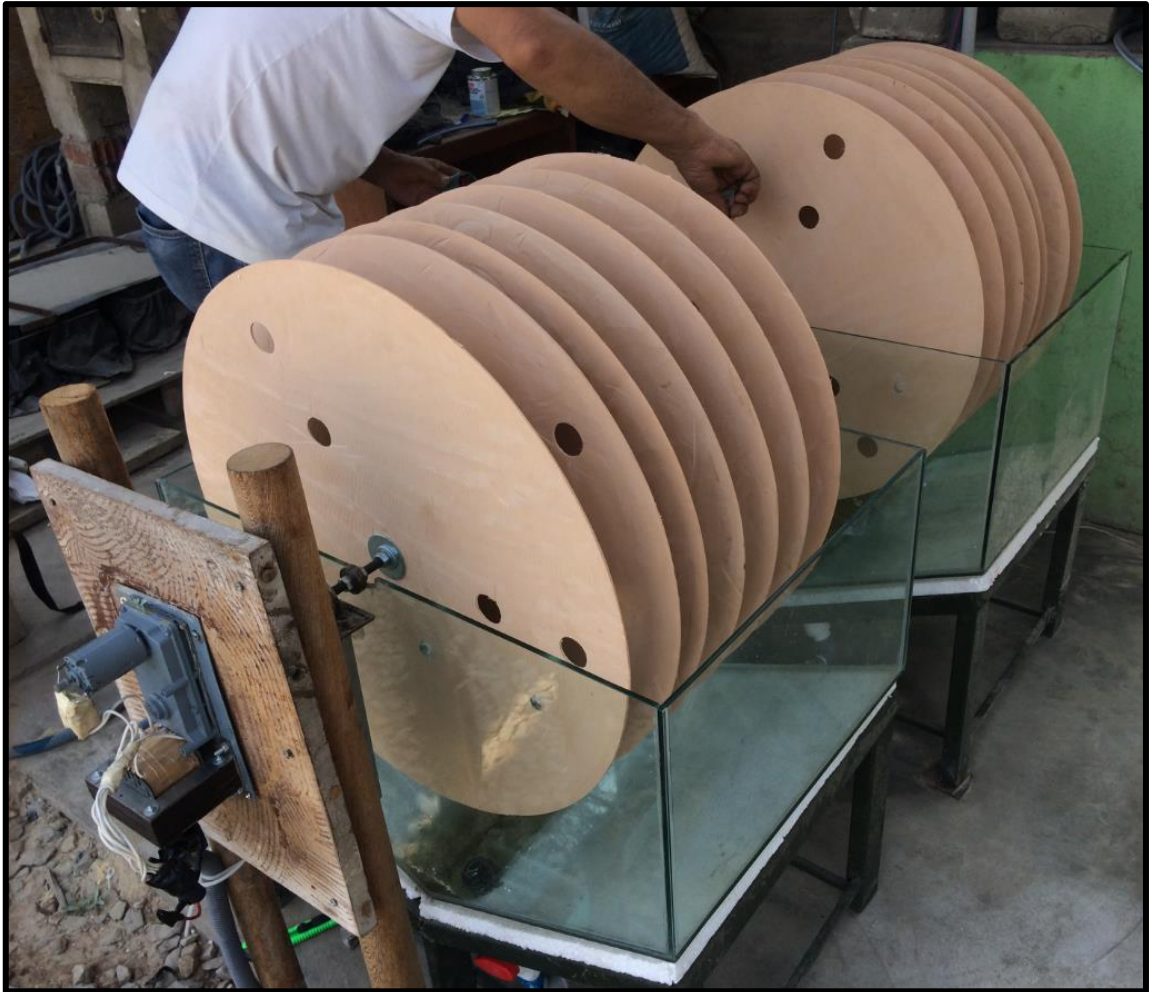
Figura 40 Montaje del RBC
