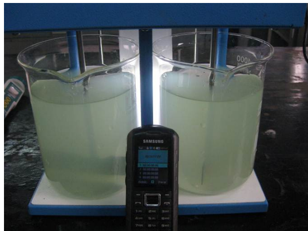
FIGURA N° 5.3.6: MUESTRA POSTERIOR A LA APLICACIÓN DEL HIPOCLORITO DE CALCIO (t=16'57'')
