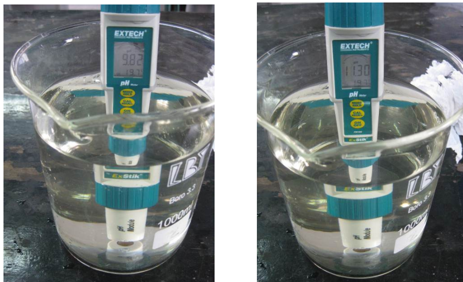
FIGURA N° 5.3.15 MEDICIÓN DEL PH A LAS MUESTRAS, IZQ (MUESTRA INICIAL 9.82) – DER (MUESTRA ACONDICIONADA 11.3)
