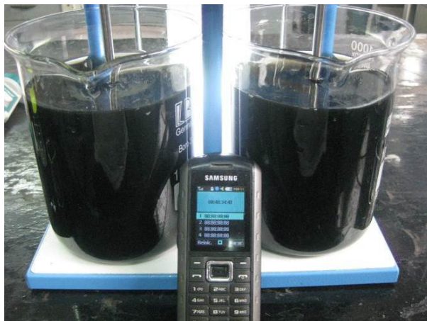
FIGURA N° 5.3.10. PRUEBA POSTERIOR A LA ADICIÓN DE SULFHIDRATO DE SODIO (t=40'34'')
