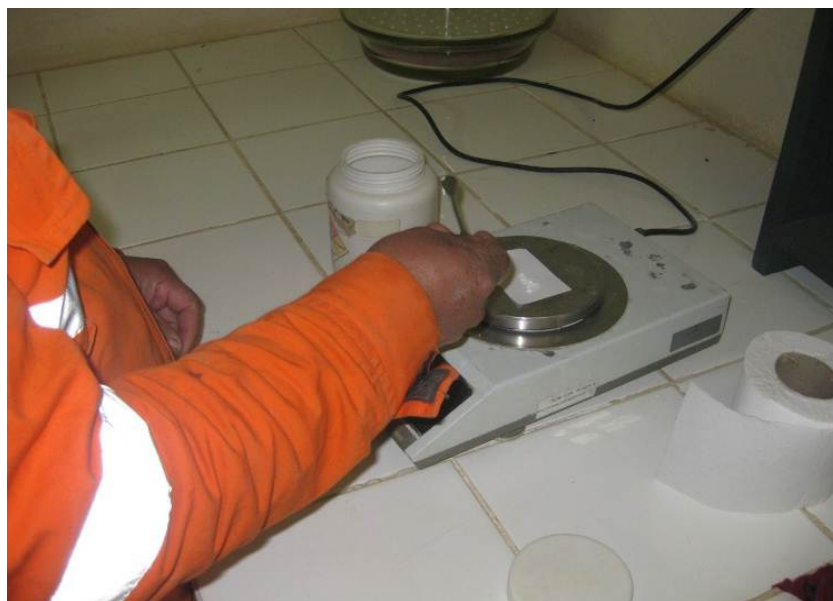
FIGURA N° 1.2. PRUEBAS EN MINA A NIVEL LABORATORIO PESADO DE HIPOCLORITO DE CALCIO (COMARSA)
