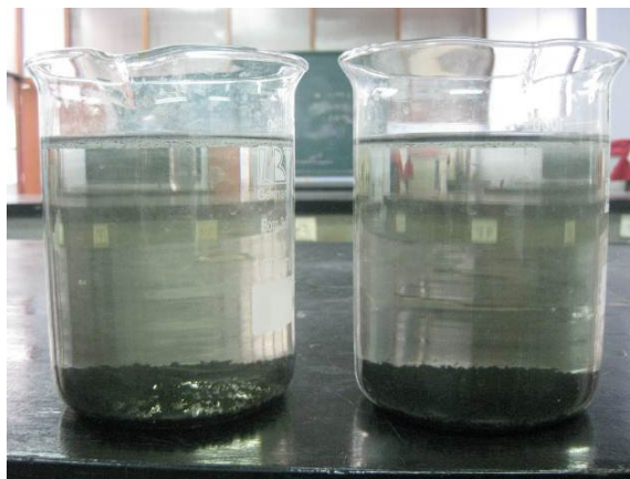
FIGURA N° 5.3.13 MUESTRA AL FINAL DE LA DECANTACIÓN (60MIN APROX.); SE APRECIA BUENA COMPACTACIÓN DEL PRECIPITADO DECANTADO, CON UNA TURBIDEZ DE HASTA 3.7 NTU.
