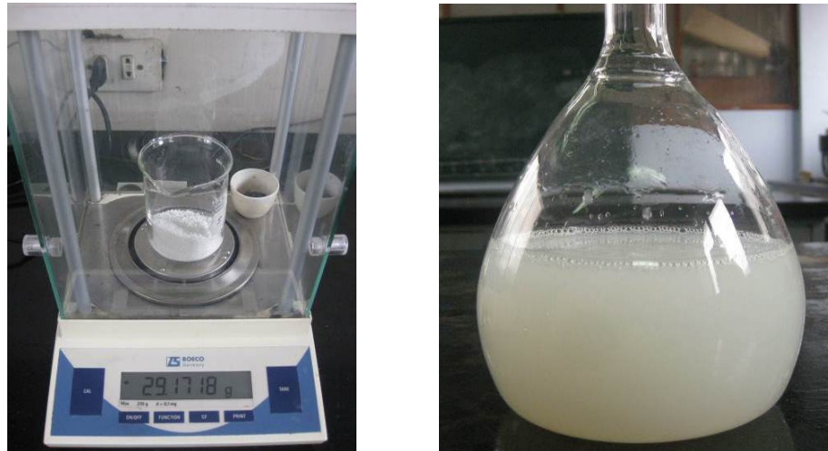
FIGURA N° 5.3.1 PREPARACIÓN DE HIPOCLORITO DE CALCIO AL 2% DE CLORO ÚTIL.
