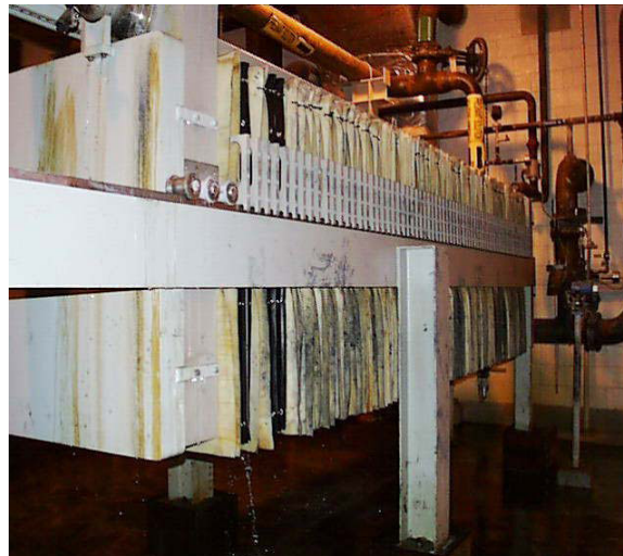
FIGURA Nº 2.12 FILTROS PARA PRECIPITACIÓN DEL ORO MINERA YANACOCCHA
