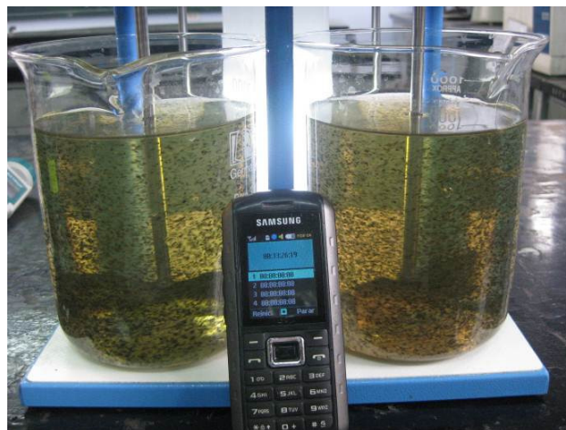
FIGURA N° 5.3.8. PRUEBA POSTERIOR A LA ADICIÓN DEL CLORURO FÉRRICO (t=33'26'')
