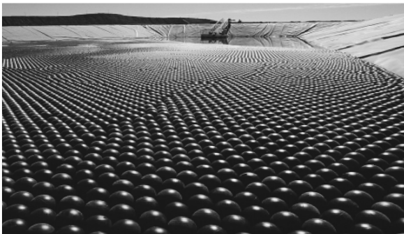
FIGURA Nº 2.17 PELOTAS FLOTANTES PARA PÁJAROS” CUBREN LA SUPERFICIE DE UN ESTANQUE DE CONTENCIÓN DE SOLUCIONES EN LA MINA DE ORO CORTEZ, UNA JOINT-VENTURE ENTRE PLACER DOME Y KENNECOTT. EN NEVADA, ESTADOS UNIDOS.
