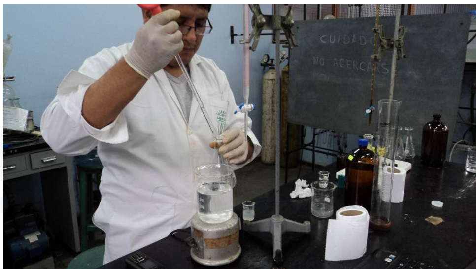
FIGURA N° 5.2.3 EXTRACCIÓN DE MUESTRA PARA TITULACIÓN CON RHODAMINA Y NITRATO DE PLATA
