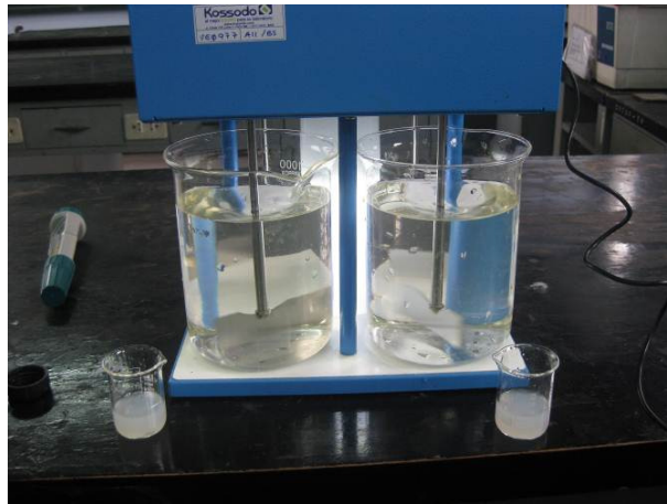
FIGURA N° 5.3.3 EQUIPO DE PRUEBA DE JARRAS AL INICIO DEL TRATAMIENTO
