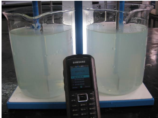
FIGURA N° 5.3.5 MUESTRA POSTERIOR A LA APLICACIÓN DEL HIPOCLORITO DE CALCIO (t=2'54'')
