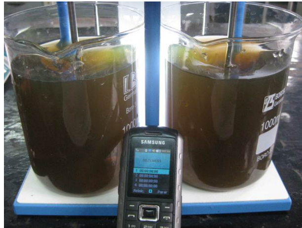
FIGURA N° 5.3.7. PRUEBA POSTERIOR A LA ADICIÓN DEL CLORURO FÉRRICO (t=21'04'')
