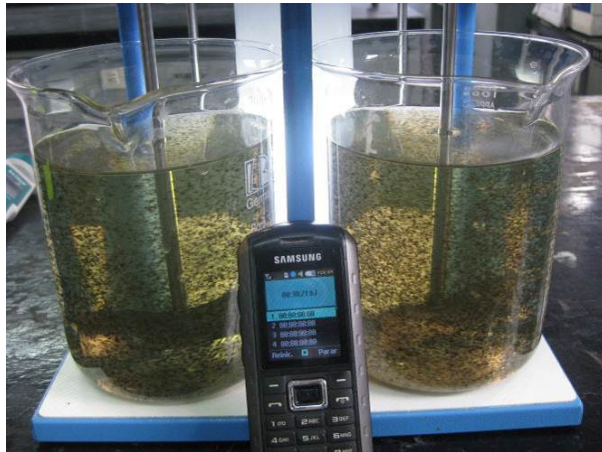
FIGURA N° 5.3.9. PRUEBA POSTERIOR A LA ADICIÓN DEL CLORURO FÉRRICO (t=38'21'')
