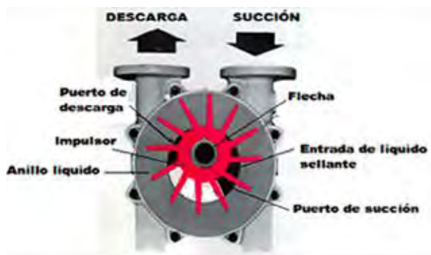
FIGURA 2.5 Esquema de la bomba de vacío de anillo líquido
